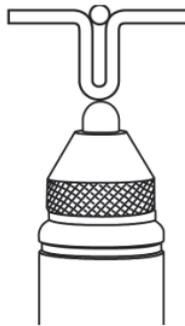
**Figura 4-16 Misura non precisa a causa della curvatura della superficie**
