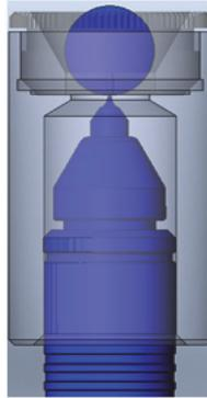
**Figura 4-7 Allineamento del disco al bordo della punta del cappuccio a punta**
