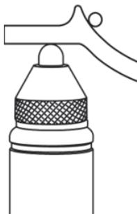
**Рис. 4-15 Неправильное измерение. Шарик заблокирован**
