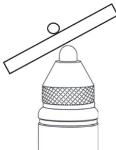
**Рис. 4-17 Неправильное измерение. Преобразователь и элемент не выравнены**
