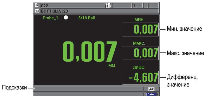
Рис. 2-2 Дополнительные значения, отображаемые на экране измерений
