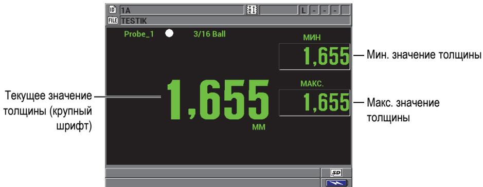
Рис. 5-3 Отображение мин. и макс. значений толщины
