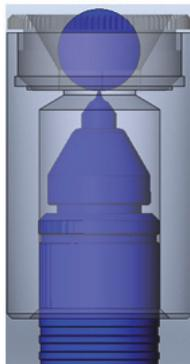
**Рис. 4-7 Выравнивание диска на заостренном колпачке ПЭП**
