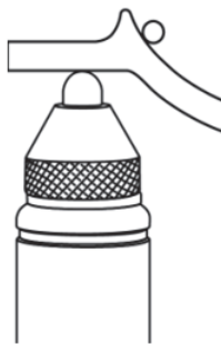
图 4-15 不正确的测量方法：目标滚珠受到阻挡
