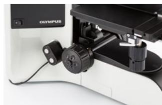
Handschalter für motorgesteuerte Objektivrevolverdrehung
