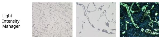
Die Lichtstärke wird automatisch angepasst, um ein optimales Bild zu erzeugen, auch wenn Vergrößerung oder Mikroskopiemethode geändert werden.
