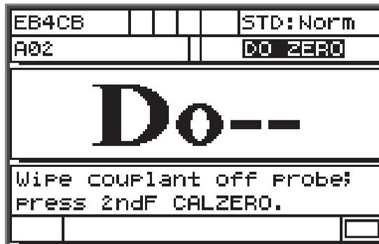
Abbildung 5-2 Fenster Do-- mit unbekannter Schallgeschwindigkeit im Material
