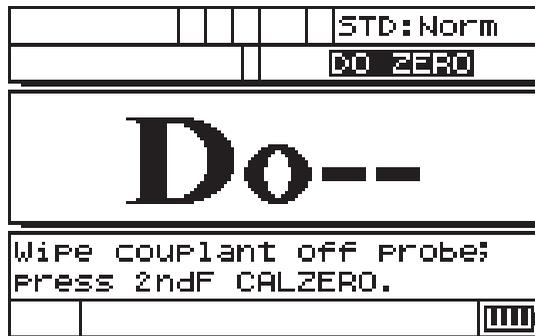
Abbildung 4-1 Nullpunktausgleich des Messkopfs
