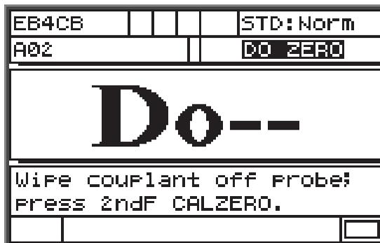
图 5-2 未知声速材料的零位补偿屏幕
