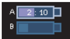
Figura 2-4 Stato di carica delle batterie: Carica residua in entrambe le batterie
