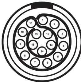
Obrázek 8-1 I/O LEMO konektor (letovací strana)
