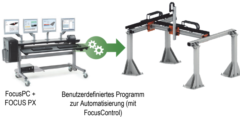
Abbildung i-4 System zur Automatisierung mit FocusControl (Beispiel)
