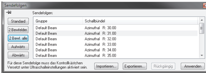
Abbildung 4-52 Sendefolgen mit versetzten Schallbündelpaaren in allen Gruppen
