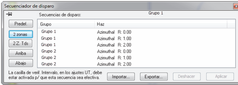
Figura 4-51 Ejemplo de secuencia de disparo con pares entrelazados de 2 zonas
