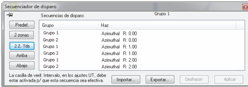
Figura 4-52 Ejemplo de una secuencia de disparo con pares de haces entrelazados de 2 Z. Tds: Todos los pares entrelazados
