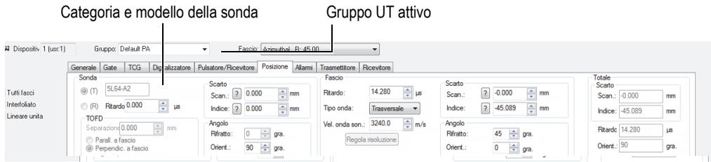
**Figura 4-25 Selezione della sonda nella finestra di dialogo Configurazioni UT**
