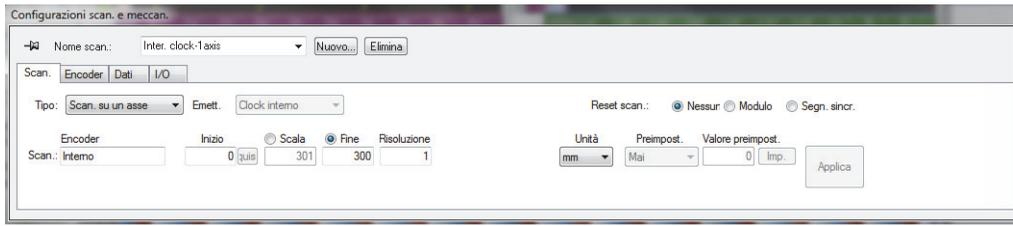
**Figura 3-6 La scheda Scan. della finestra di dialogo Configurazioni di scansione e meccaniche**
