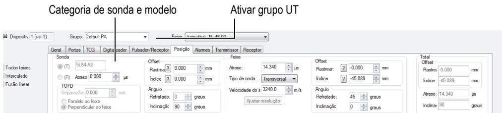
**Figura 4-25** Selecionar a sonda na caixa de diálogo Configurações de UT
