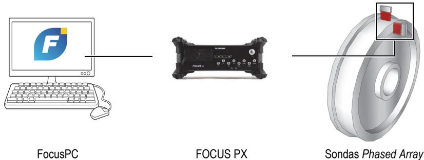
**Figura i-2 Exemplo do sistema FocusPC/FOCUS PX**
