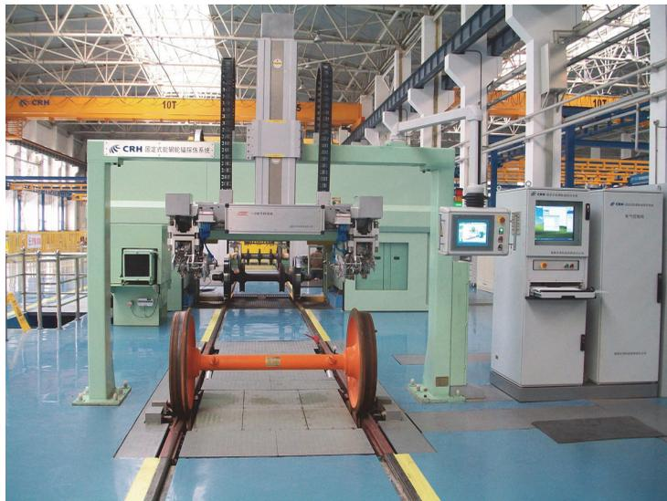
Figura i-1 Exemplo de um sistema de inspeção completamente automatizado<sup>1</sup>
