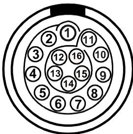
**Figura 7-3 Connettore LEMO dell'adattatore d'interfaccia dello scanner (lato saldatura)**
