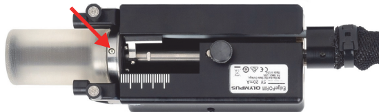
Abbildung 2-1 Befüllen der Wasserkammer des Rollensors
