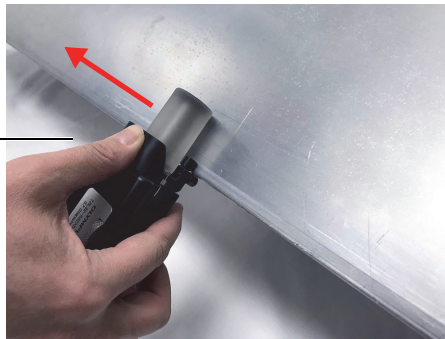
Figure 3-1 Balayage pendant l'inspection
