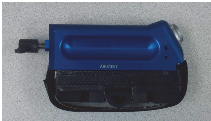
Abbildung 2-6 Um Sonde und Keil gewickelter Klettstreifen
