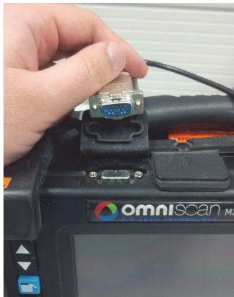
Abbildung 2-12 Anschluss des Weggeberkabels an das OmniScan-MX-Prüfgerät
