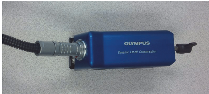
Abbildung 2-7 Anschluss des Kabels an der Sonde
