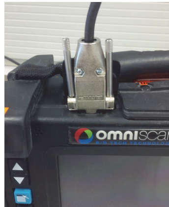
Abbildung 2-12 Anschluss des Weggeberkabels an das OmniScan-MX-Prüfgerät
