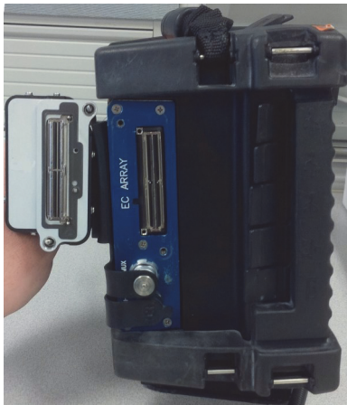
Abbildung 2-11 Anschluss des Adapters an das OmniScan-MX-Prüfgerät
