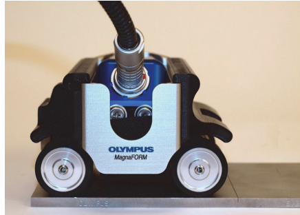
Abbildung 4-1 Die Sonde auf dem Referenzstandard
