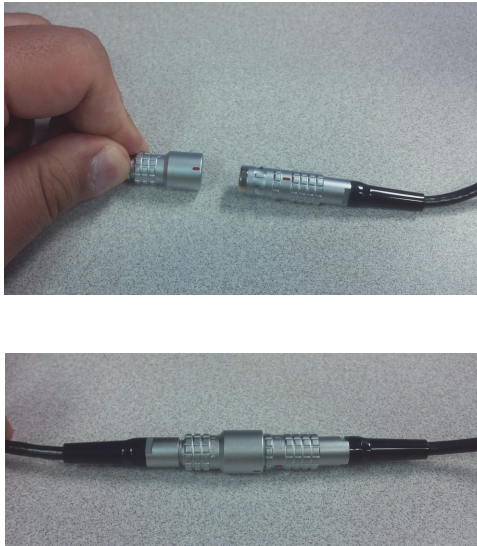
Abbildung 2-9 Verbindung der Abschnitte des Weggeberkabels
