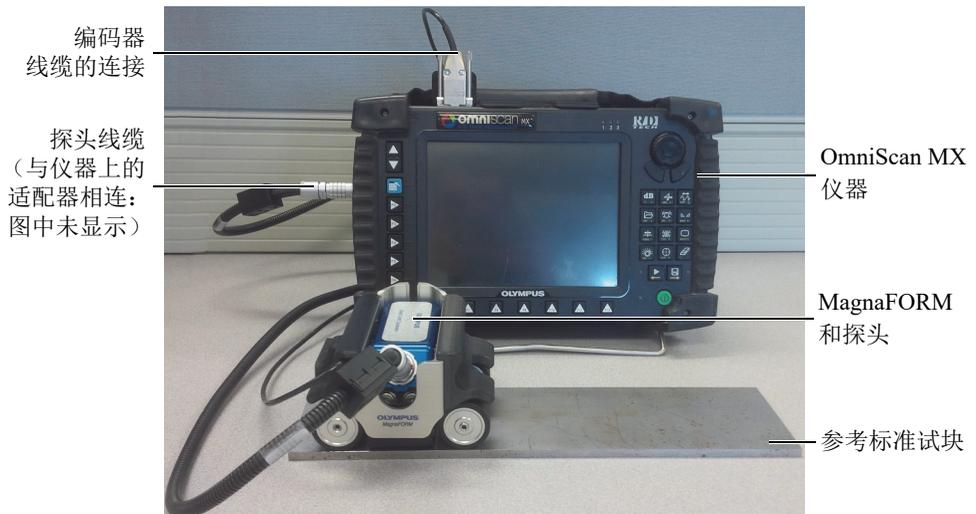
图 1-1 一个检测配置的示例
