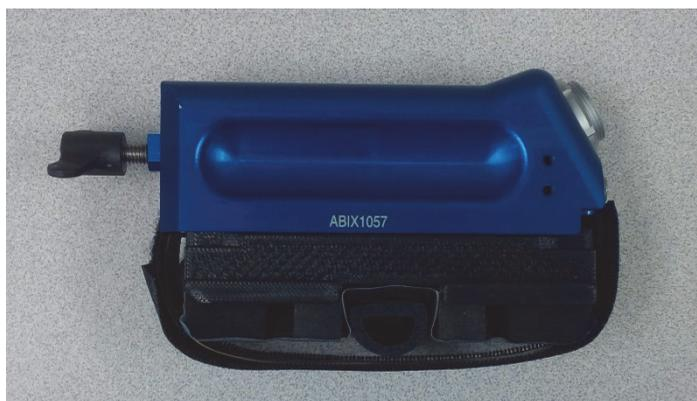
图 2-6 缠绕在探头和楔块上的维可牢条带
