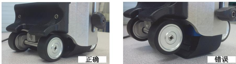
图 5-1 正确（左图）和错误（右图：太低）探头位置的示例
