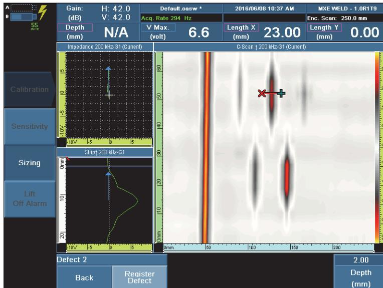
图 4-4 放置光标，以记录缺陷（图中显示为 2 毫米深度的缺陷）
