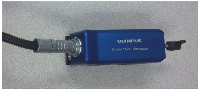
图 2-7 将线缆连接到探头上
