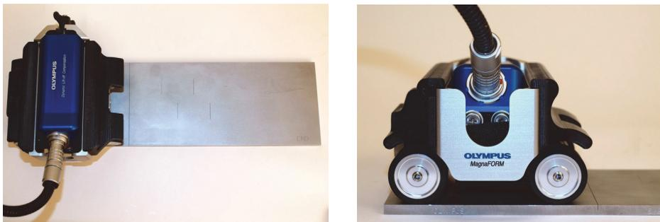
图 4-1 参考标准试块上的探头
