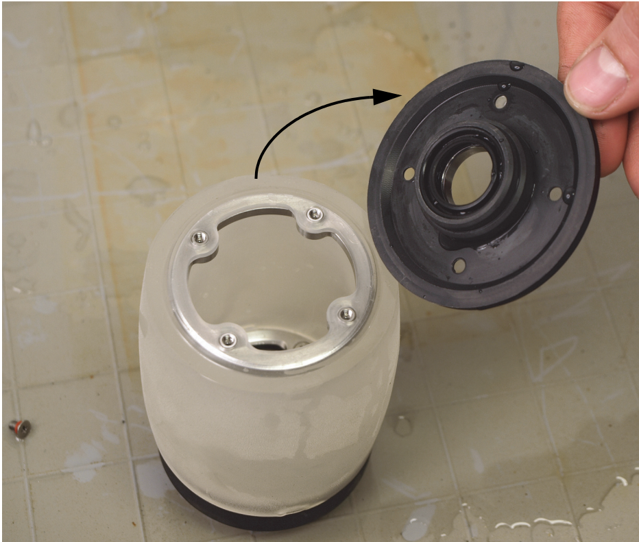
Obrázek 6-17 Odstranění hladké příruby akustického kotouče
