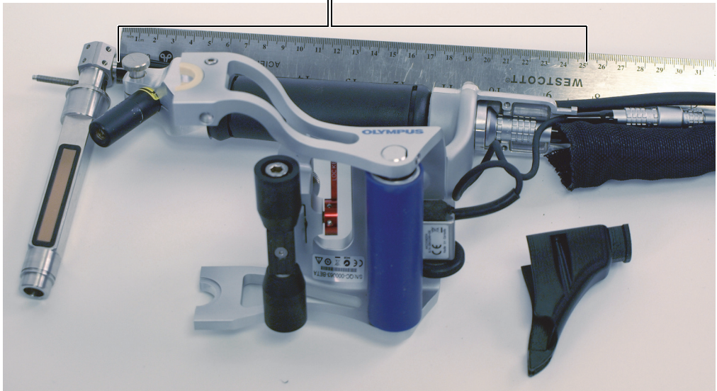
Obrázek 6-13 Kabel sondy přesahující z přední do zadní části rukojeti skeneru RollerFORM
