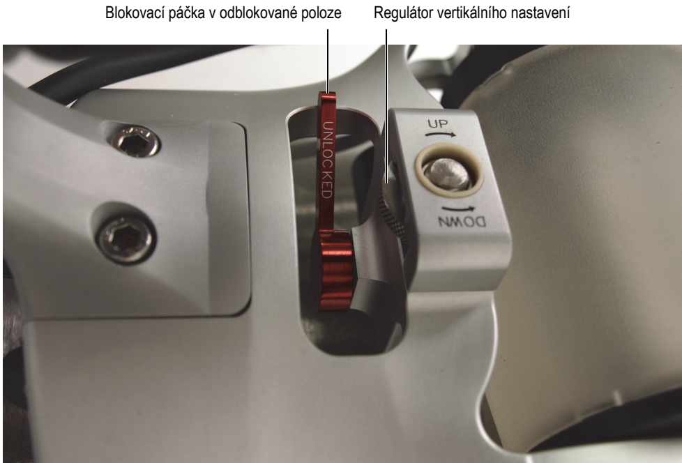
Obrázek 4-2 Odblokování středového kotouče
