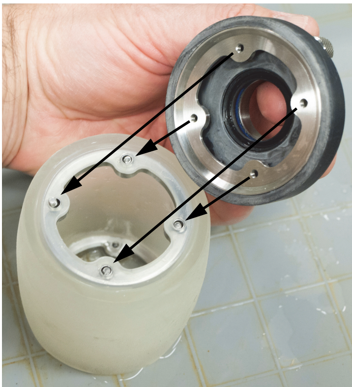
Obrázek 6-26 Instalace příruby s regulačními ventily kapaliny
