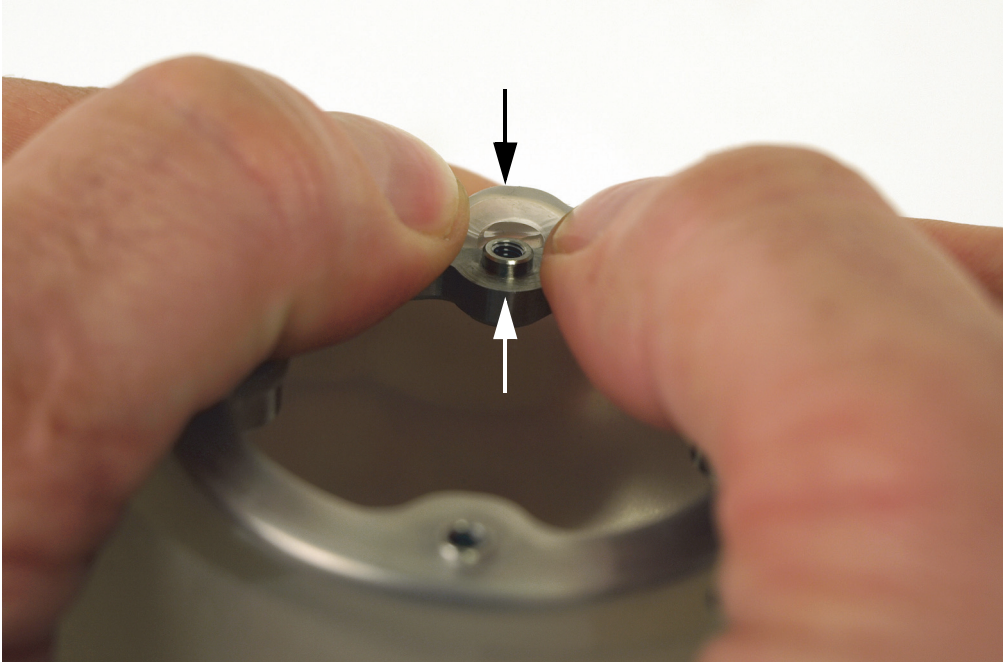
Obrázek 6-25 Instalace prstence do jeho pojistné drážky v pryžovém disku
