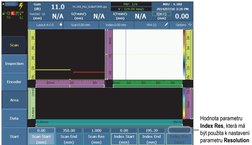
Obrázek 2-7 Indexovací hodnota v OmniScan
