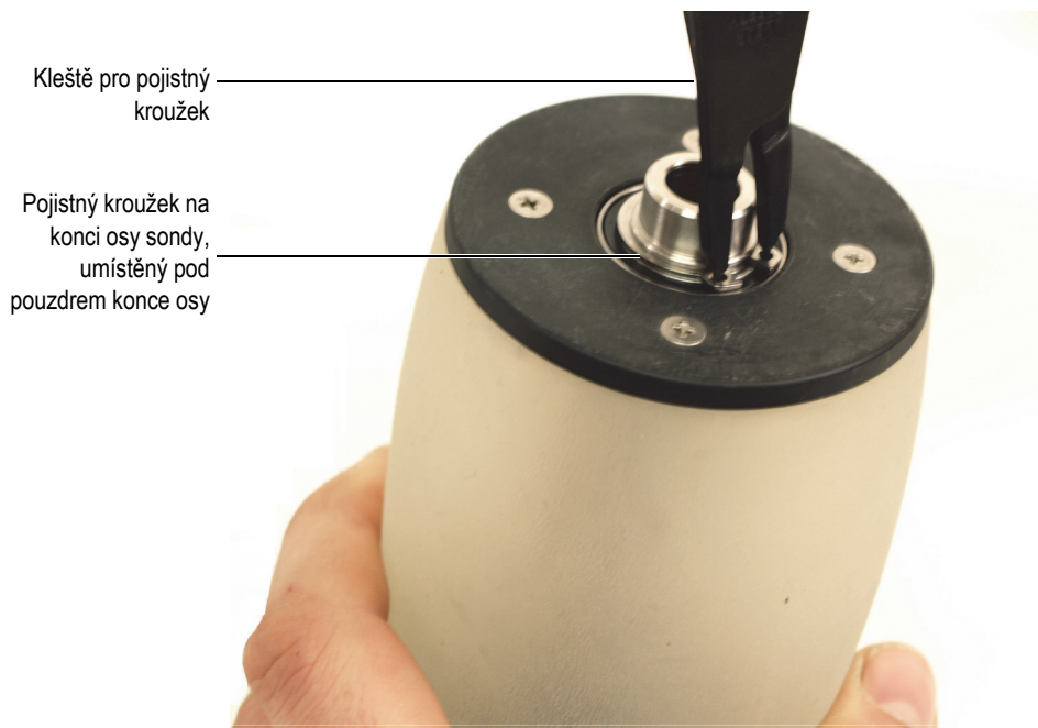
Obrázek 6-7 Odstranění vnějšího pojistného kroužku z konce osy sondy
