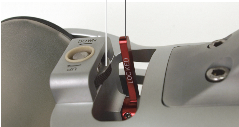
Obrázek 4-3 Blokování středového kotouče
