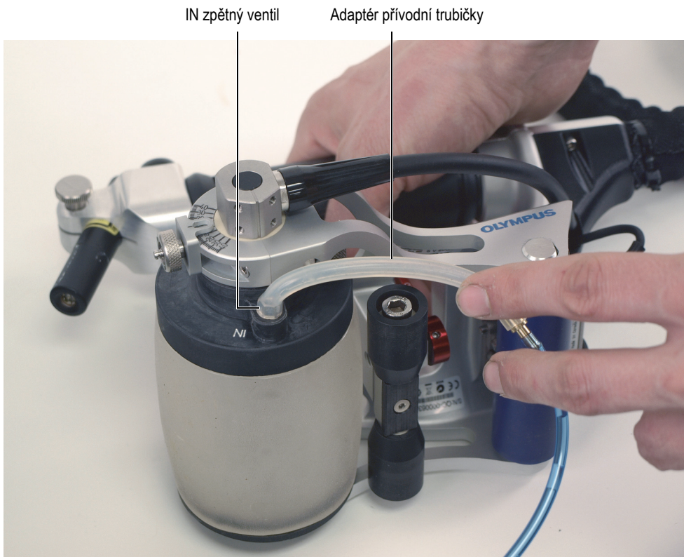
Obrázek 3-2 Připojení adaptéru přívodní trubičky na IN zpětný ventil
