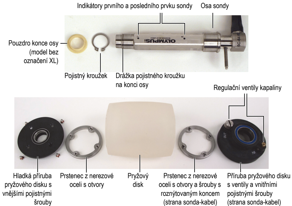
Obrázek 1-3 Součásti akustického kotouče
