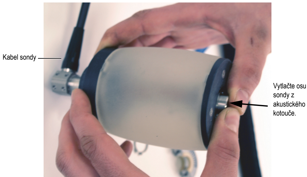
Obrázek 6-8 Vytlačení osy sondy z akustického kotouče
