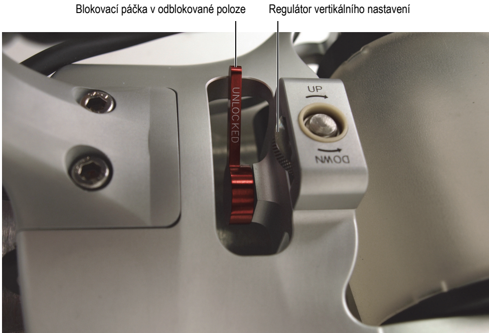
Obrázek 4-4 Odblokování středového kotouče
