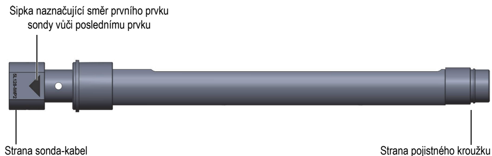
Obrázek 5-2 Šipka na ose sondy naznačující směr od prvního do posledního prvku na sondě
