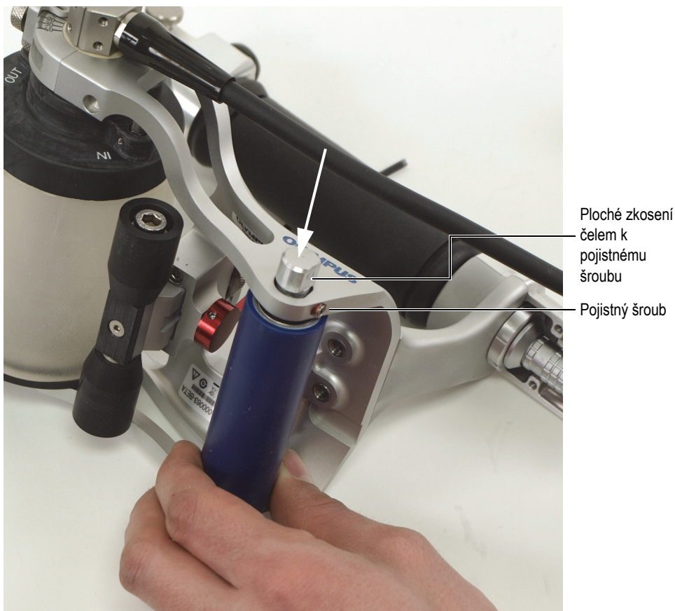
Obrázek 6-38 Vyrovnání plochého zkosení konce osy zadního válečku s pojistným šroubem
