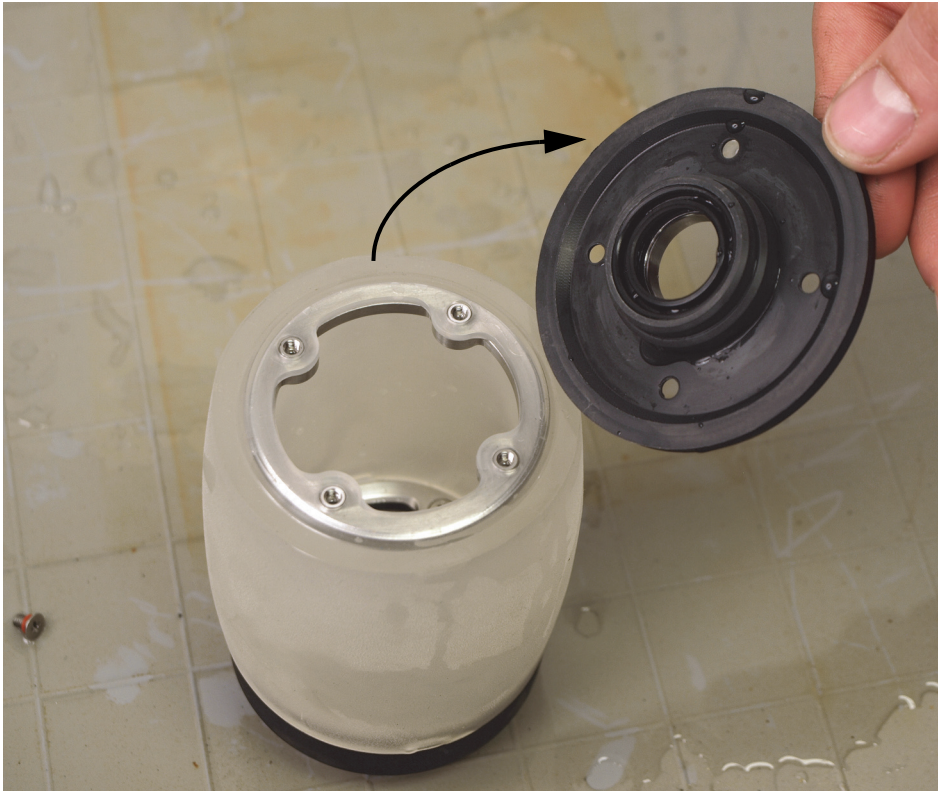
Obrázek 6-20 Odstranění hladké příruby akustického kotouče
