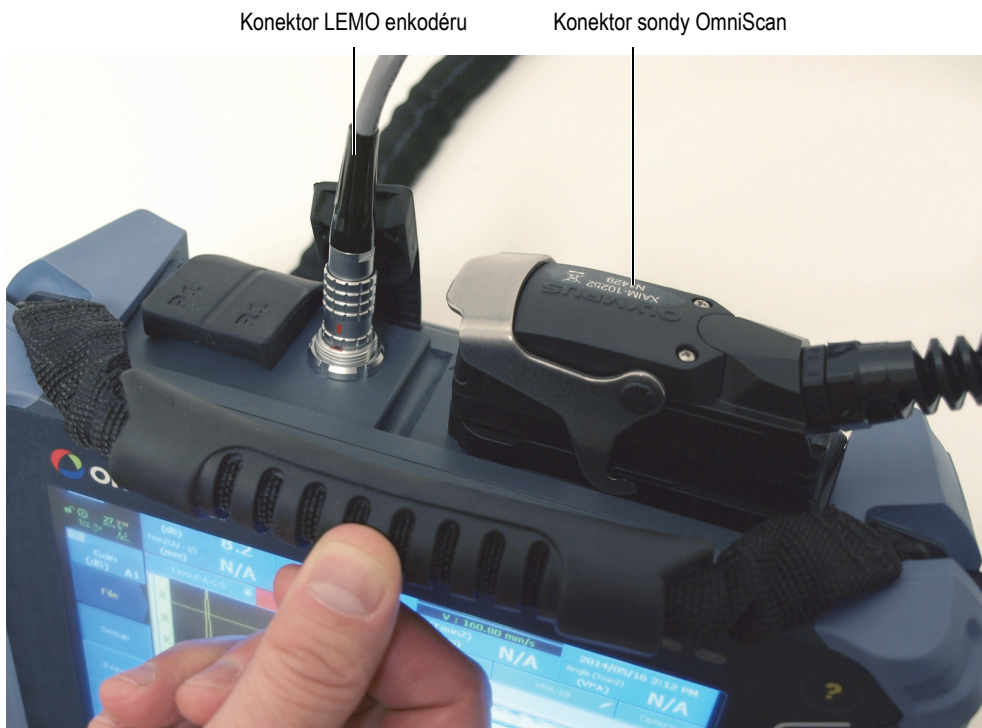
Obrázek 2-1 Přístroj OmniScan s připojenými kabely skeneru RollerFORM
