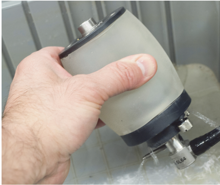
Obrázek 6-5 Vyprázdnění komory s kapalinou
