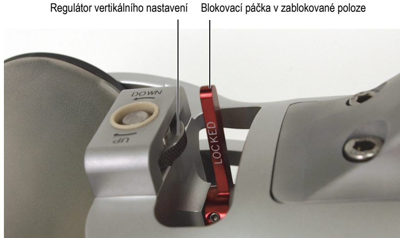
Obrázek 4-8 Blokování středového kotouče
