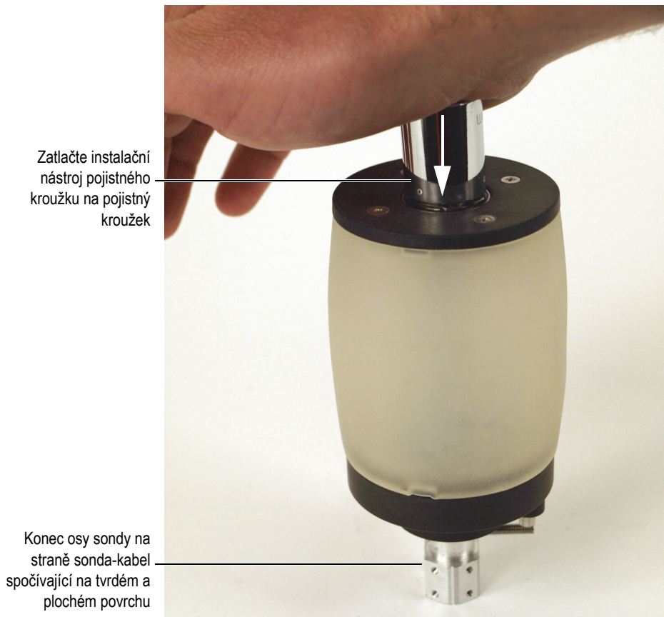
Obrázek 6-11 Vtlačení pojistného kroužku do drážky na konci osy sondy s pomocí instalačního nástroje pojistného kroužku
