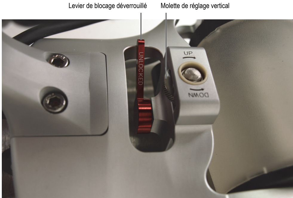
Figure 4-2 Déblocage de la roue centrale
