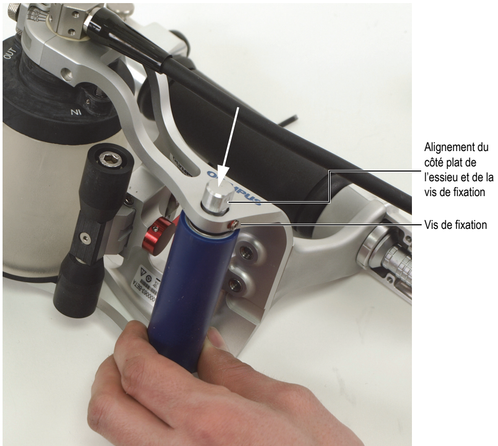
Figure 6-38 Alignement du côté plat de l'essieu et de la vis de fixation
