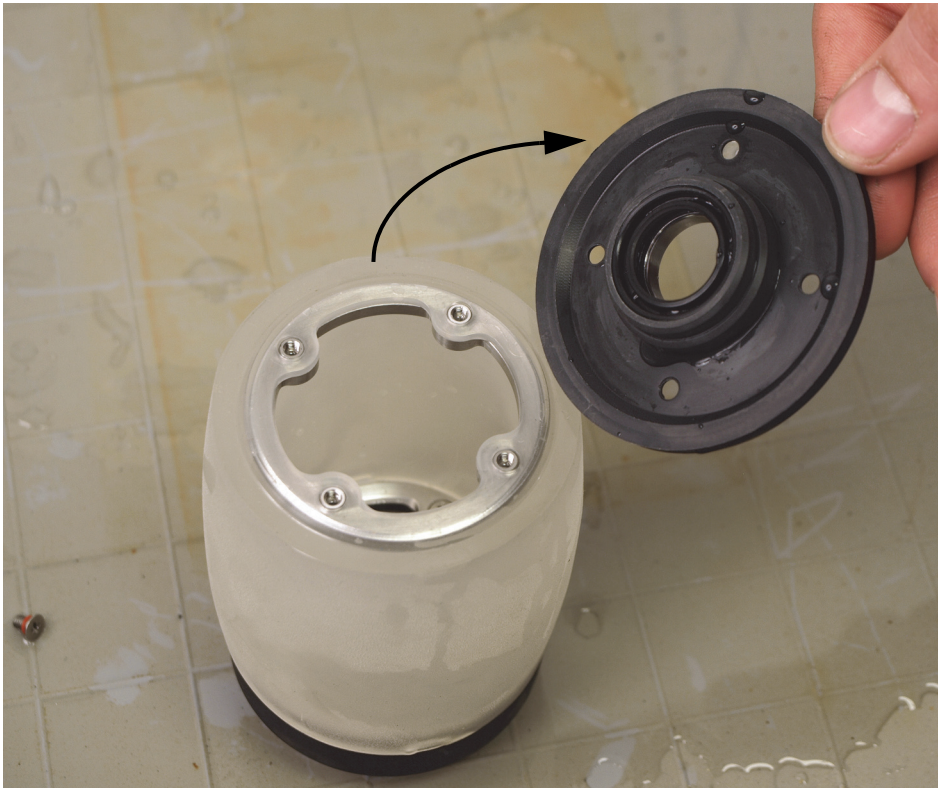
Figure 6-15 Retrait du moyeu sans régulateurs de débit de la roue acoustique
