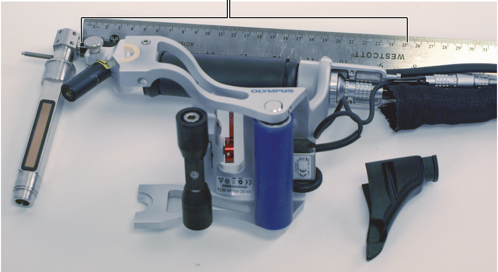
Figure 6-13 Longueur du câble de sonde à partir de l'extrémité arrière de la poignée
