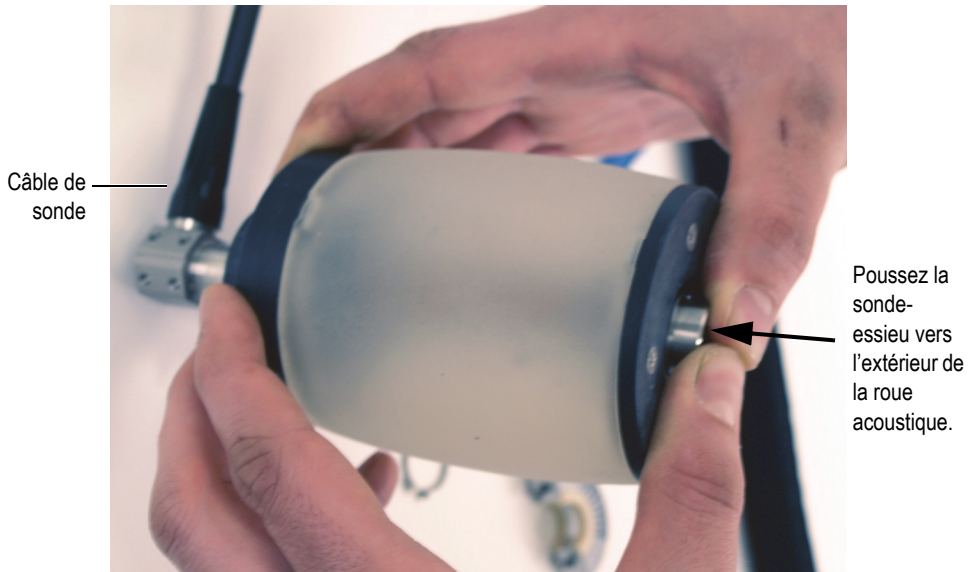
Figure 6-8 Extraction de la sonde-essieu à l'extérieur de la roue acoustique
