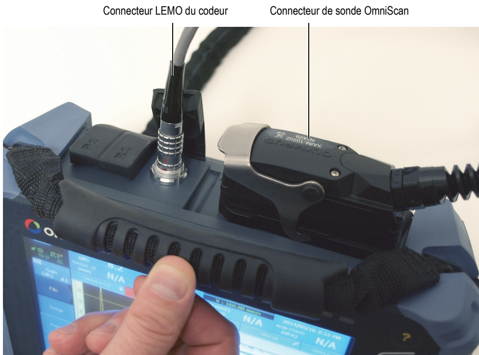
Figure 2-1 Câbles du RollerFORM connectés à l'OmniScan
