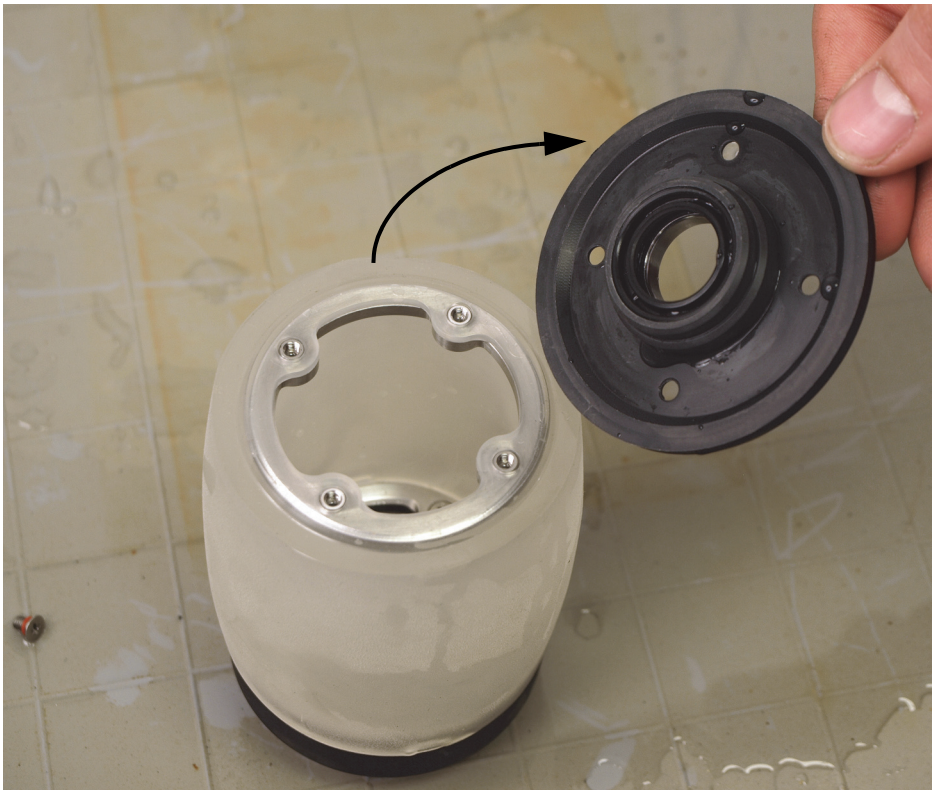
Figure 6-17 Retrait du moyeu sans régulateurs de débit de la roue acoustique
