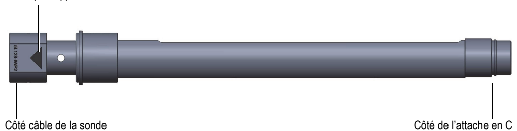
Figure 5-2 Flèche indiquant la direction du premier élément de la sonde par rapport au dernier
