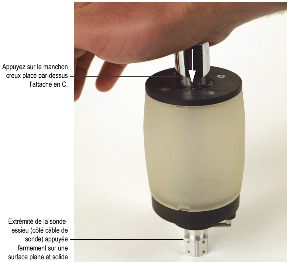
Figure 6-11 Insertion de l'attache en C dans la rainure à l'extrémité de la sonde-essieu à l'aide du manchon creux
