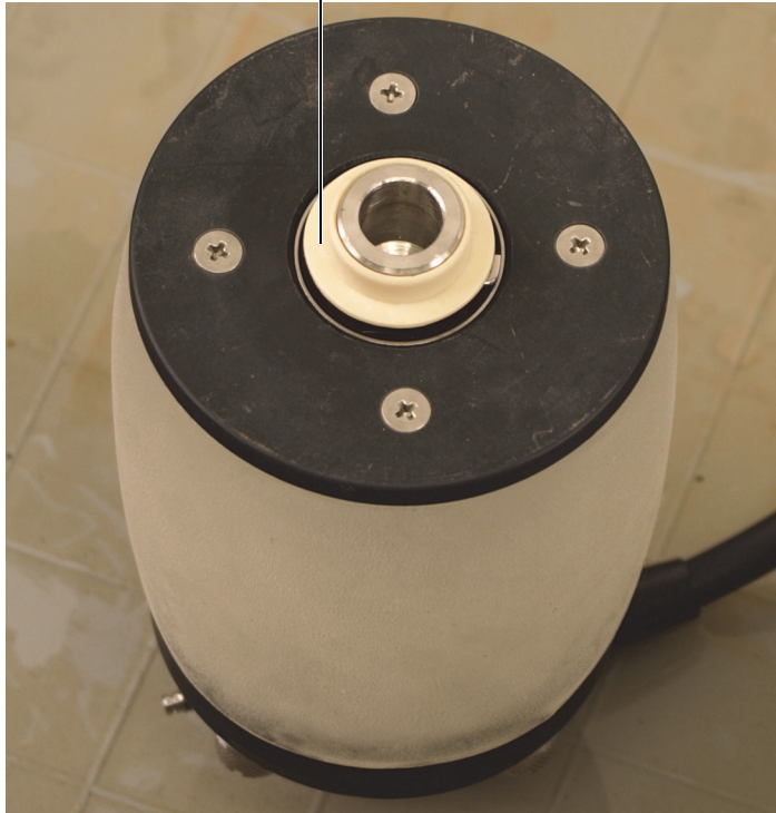
Figure 6-30 Installation de la rondelle sur l'extrémité de la sonde-essieu (modèle non XL).
