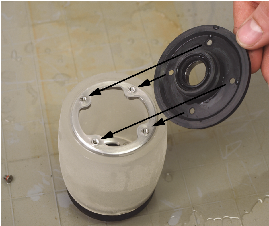
Figure 6-28 Installation du moyeu sans régulateurs de débit
