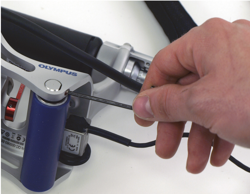
Figure 6-33 Dévissage de la vis de fixation du rouleau arrière
