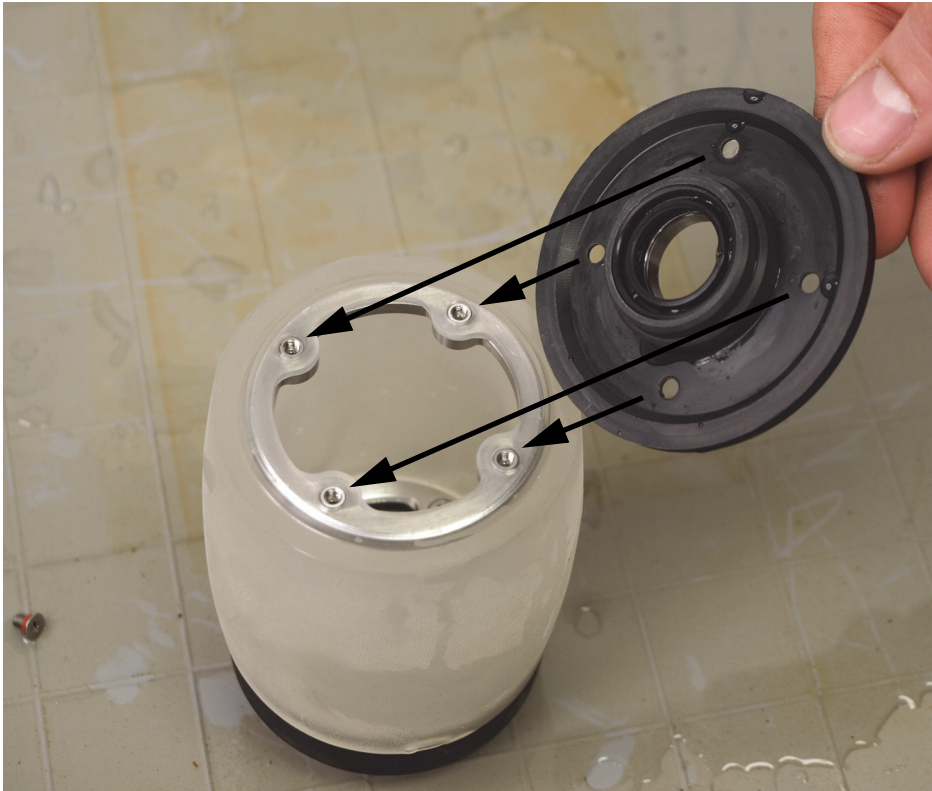
Figure 6-16 Installation du moyeu sans régulateurs de débit
