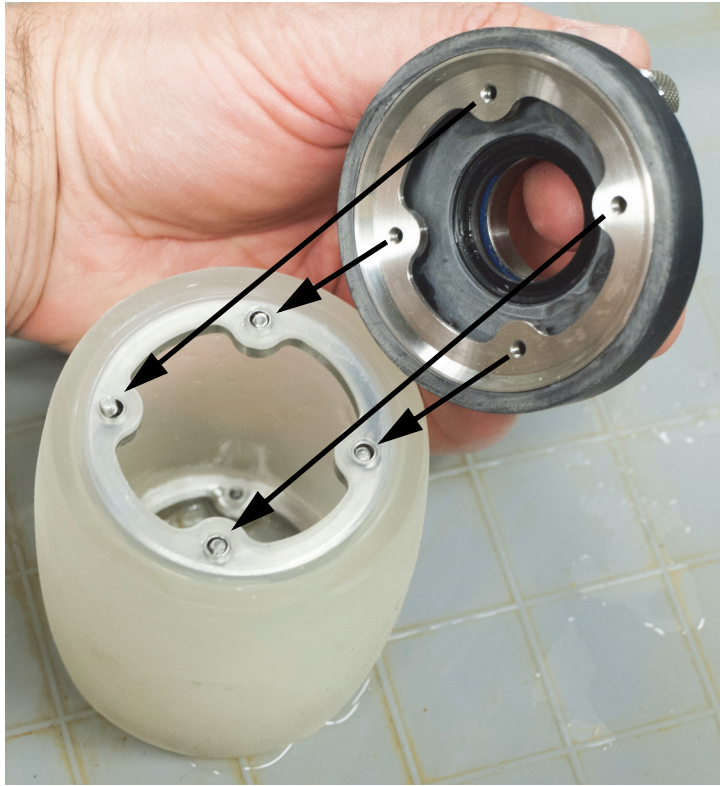
Figure 6-26 Installation du moyeu avec régulateurs de débit
