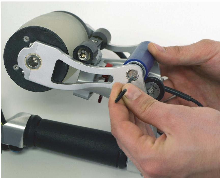
**Figura 6-34 Rimozione dell'asse della componente rotante posteriore dal proprio supporto**
