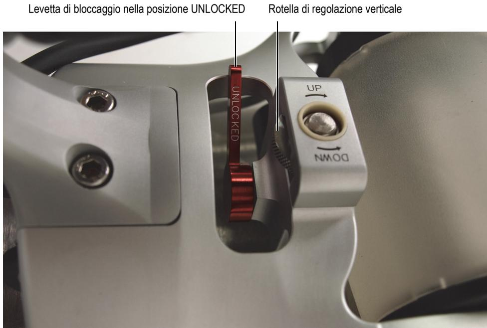
**Figura 4-5 Sbloccaggio della componente rotante intermedia**
