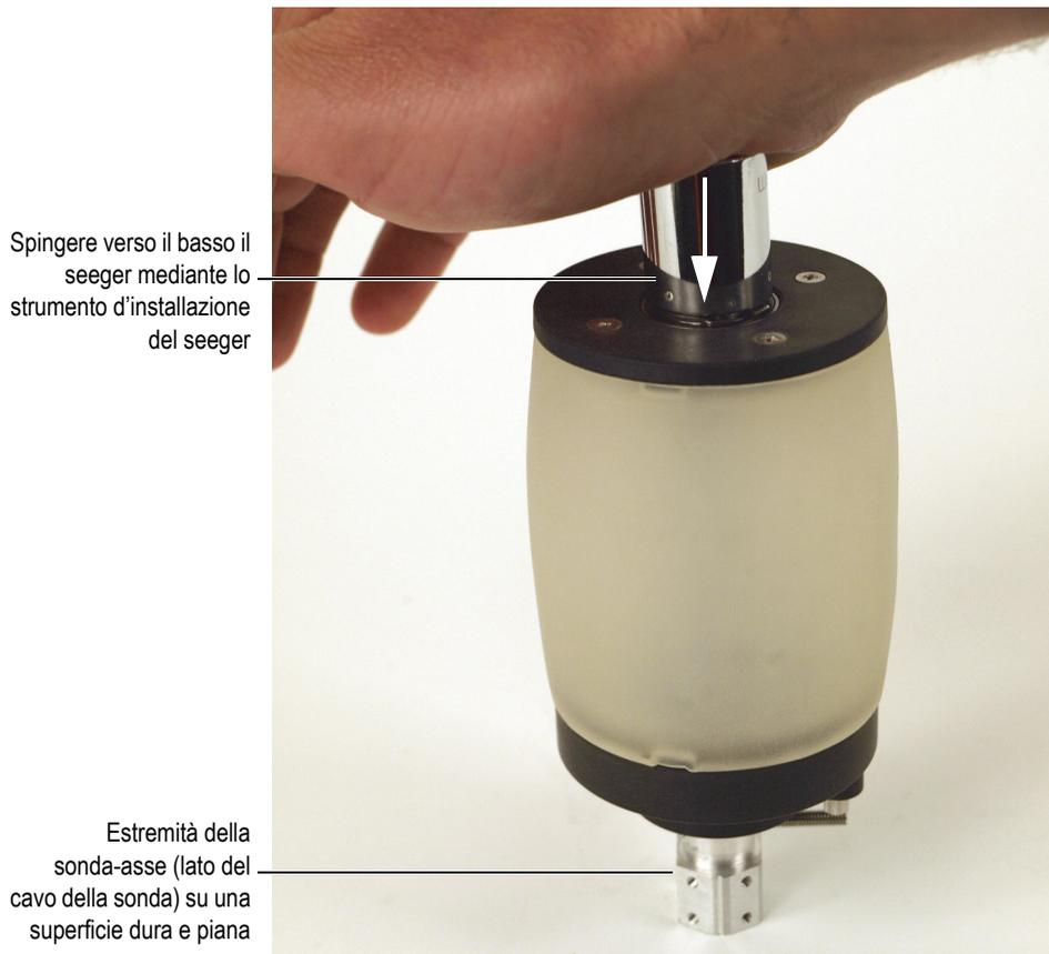
**Figura 6-11 Inserimento del seeger nella scanalatura dell'estremità della sonda-asse**
