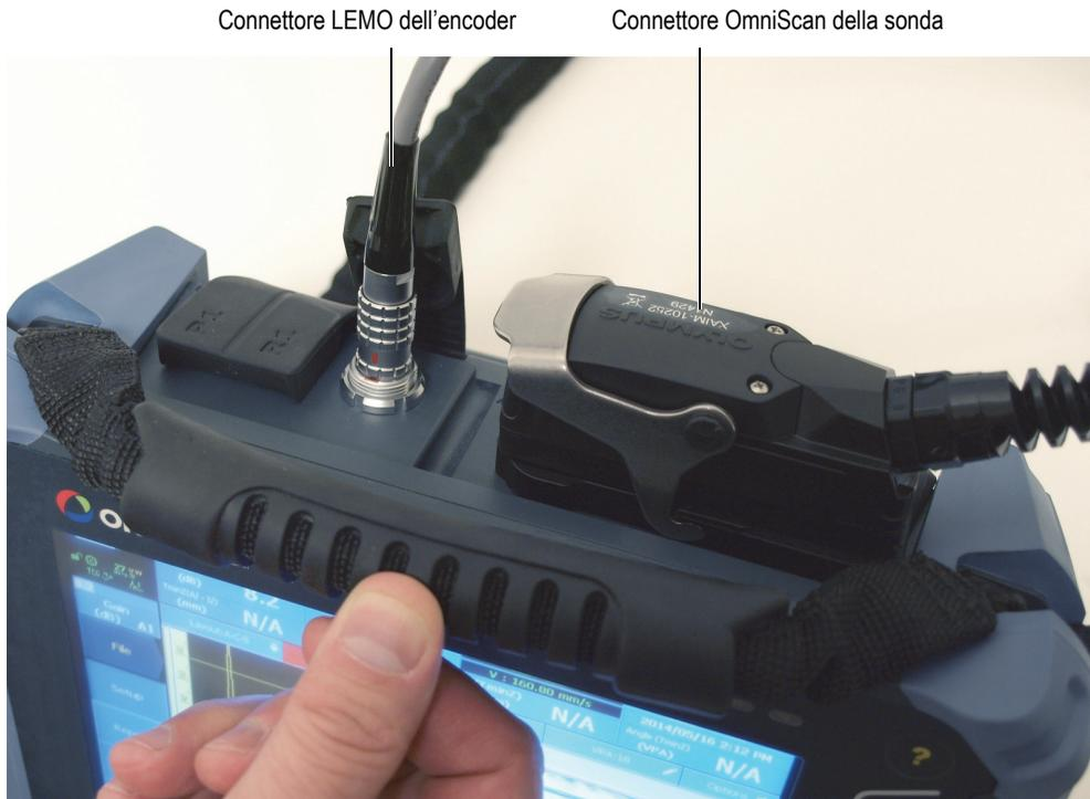
**Figura 2-1 Uno strumento OmniScan con i cavi collegati del RollerFORM**
