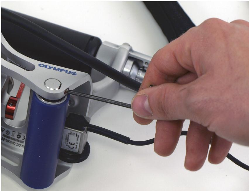
**Figura 6-33** Svitamento della vite di fissaggio della componente rotante posteriore
