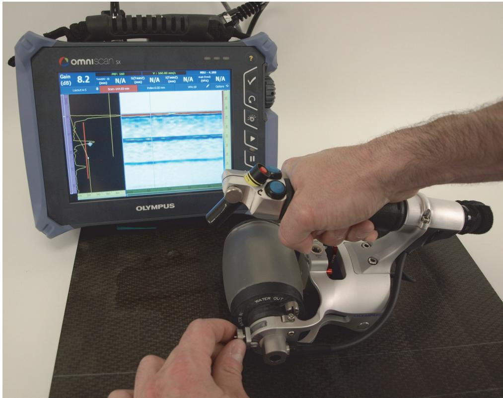
**Figura 4-1 Regolare l'angolo della sonda per ottimizzare il segnale**
