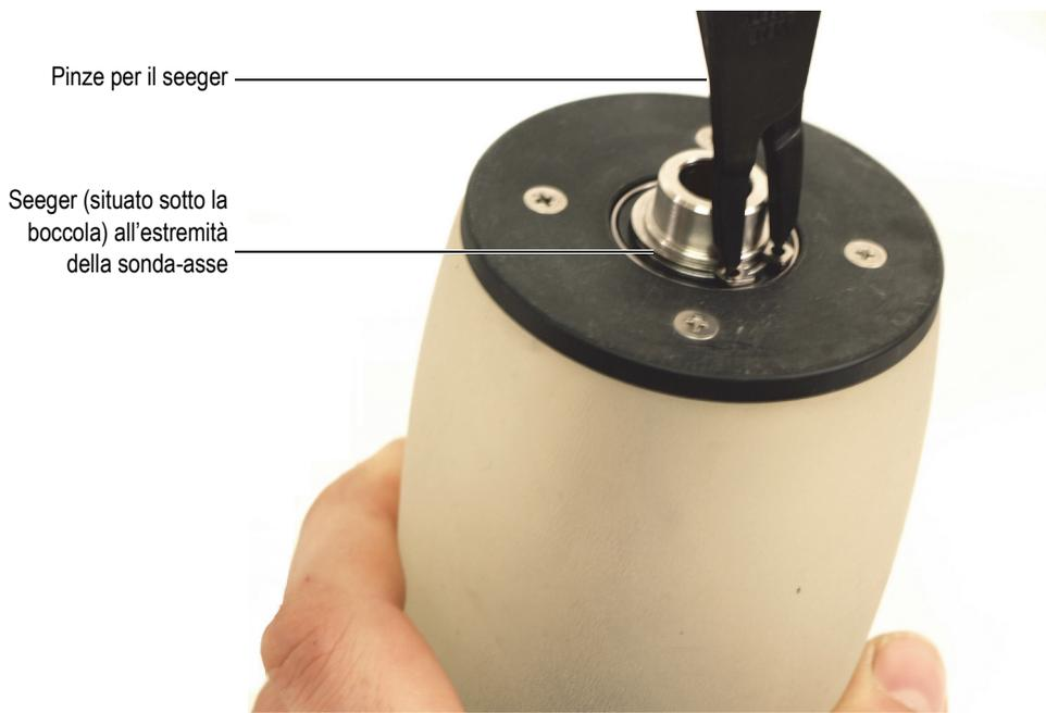
**Figura 6-7 Rimozione del seeger esterno posizionato sull'estremità della sonda-asse**
