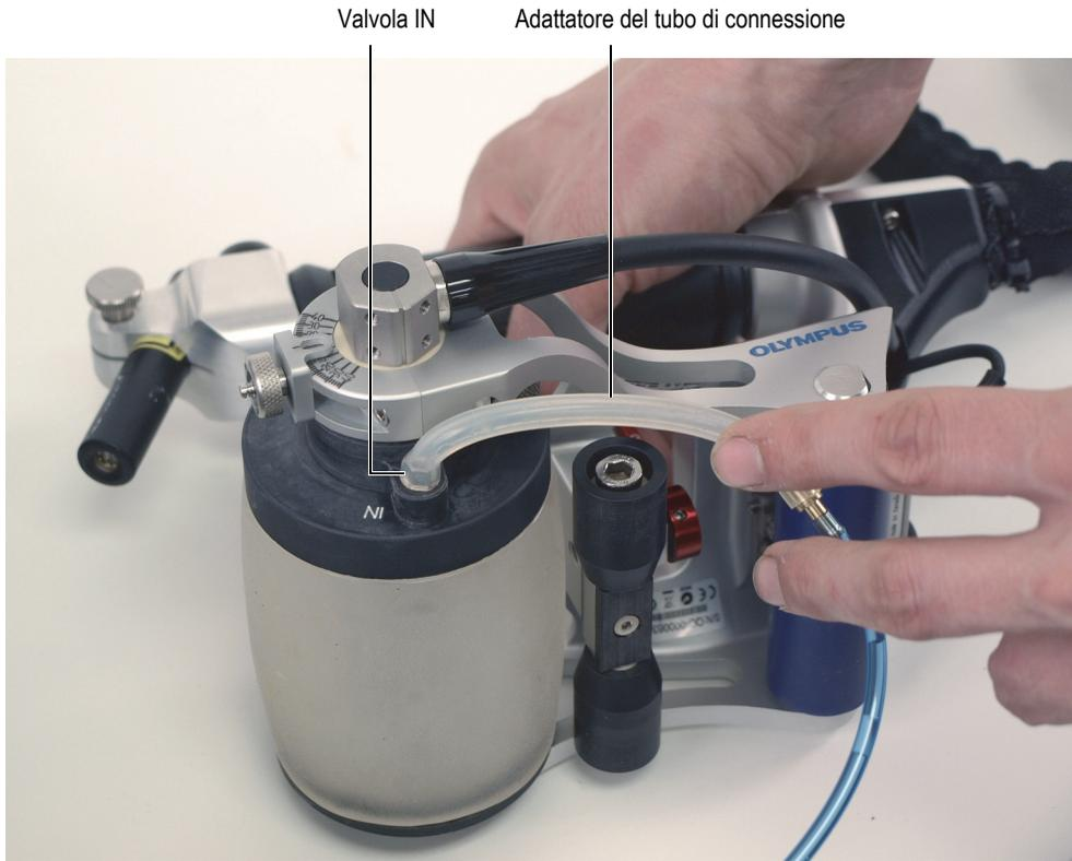
**Figura 3-2 Collegare l'adattatore del tubo di connessione alla valvola IN**
