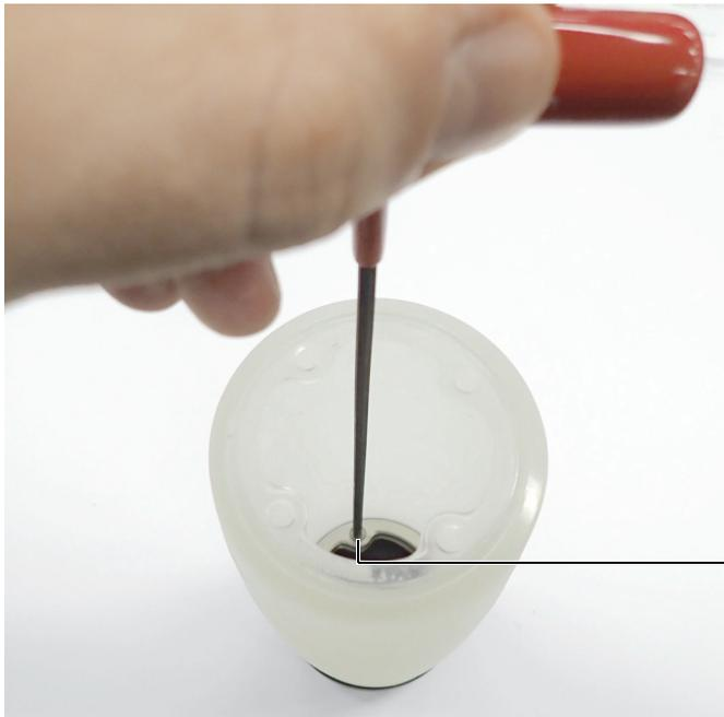
Accessibilità delle viti prigioniere dall'interno della camera del liquido
