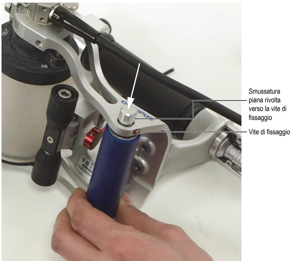
**Figura 6-38 Allineamento della smussatura piana dell'estremità dell'asse della componente rotante posteriore con la vite di fissaggio**
