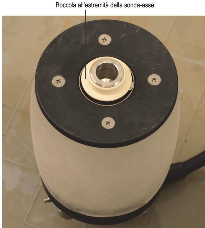
**Figura 6-30** Installazione della boccola sull'estremità della sonda-asse
