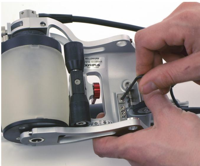
**Figura 6-36 Svitamento della vite di fissaggio dell'encoder**
