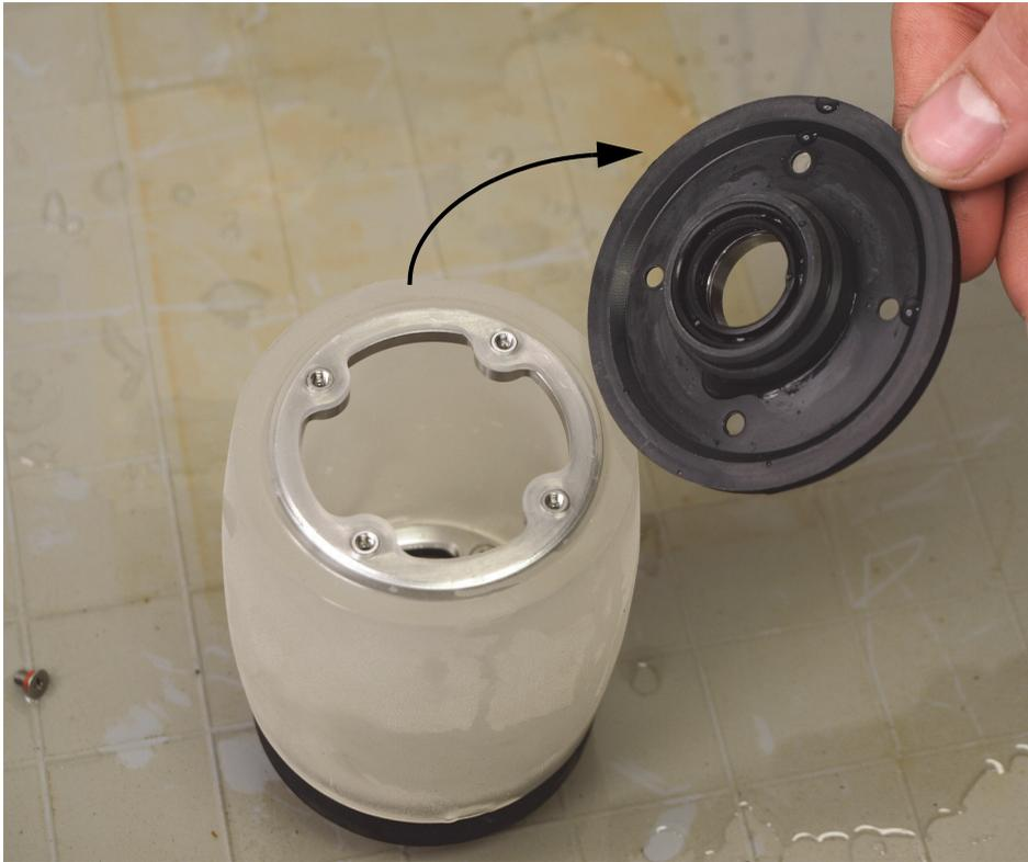
**Figura 6-20 Rimozione della flangia semplice dalla componente rotante acustica**
