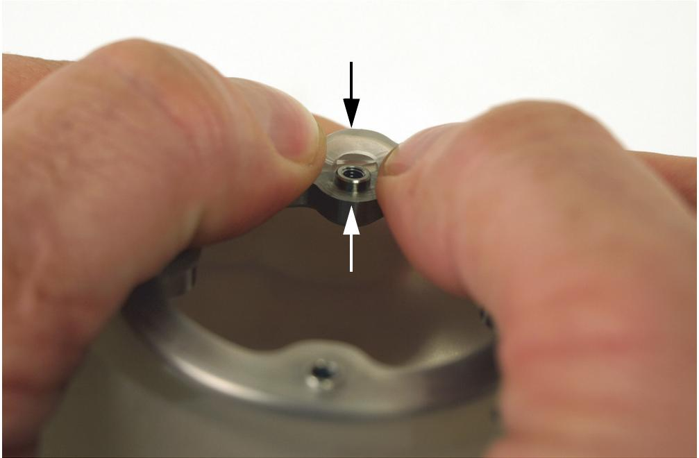
**Figura 6-25 Installazione di un anello nella rispettiva scanalatura di alloggiamento nel rullo**
