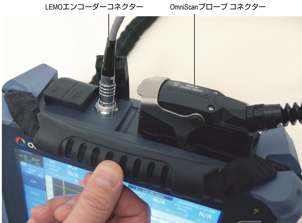
図 2-1 RollerFORM ケーブルが接続された OmniScan 装置
