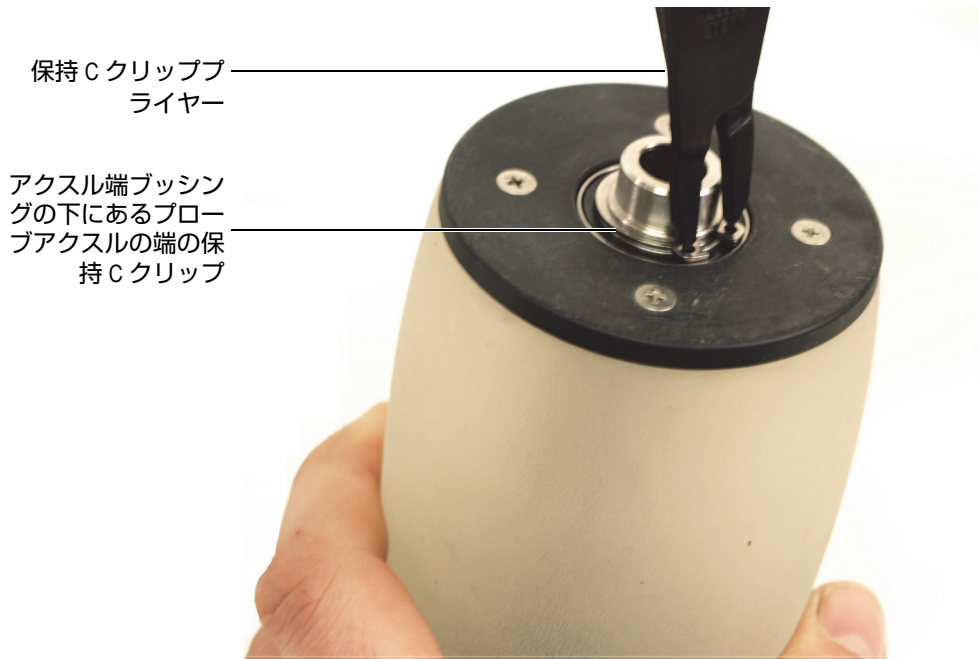
図 6-7 プローブアクスルの端から外側保持Cクリップを取り外し
