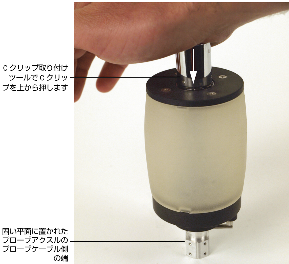
図 6-11 プローブアックスルエンドの溝にはめたCクリップをCクリップ取り付けツールで押す
