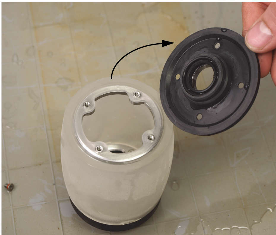
図 6-15 アコースティックホイール プレーンフランジの取り外し
