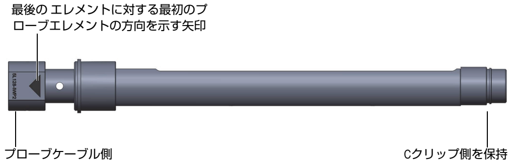
図 5-2 プローブの最初のエレメントから最後のエレメントの方向を示すプローブアクスル上の矢印
