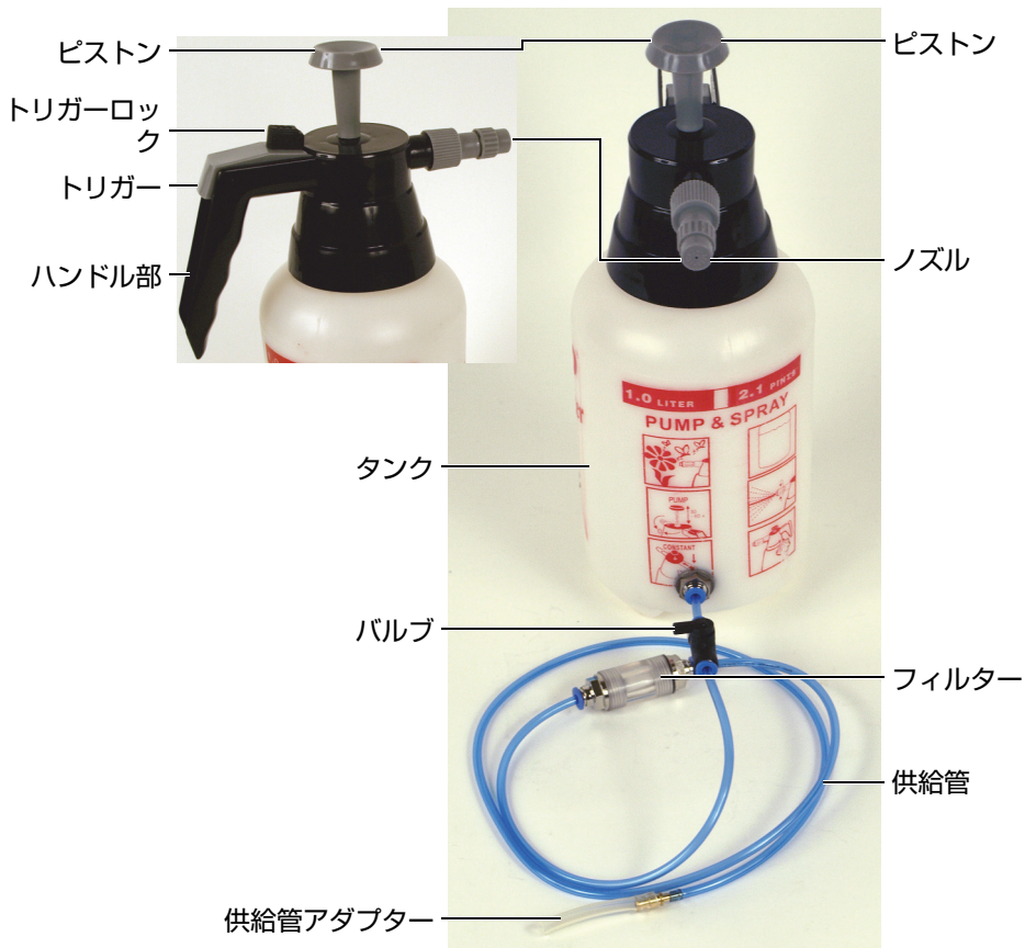
図 1-5 1.0 L 手動ポンプと供給管
