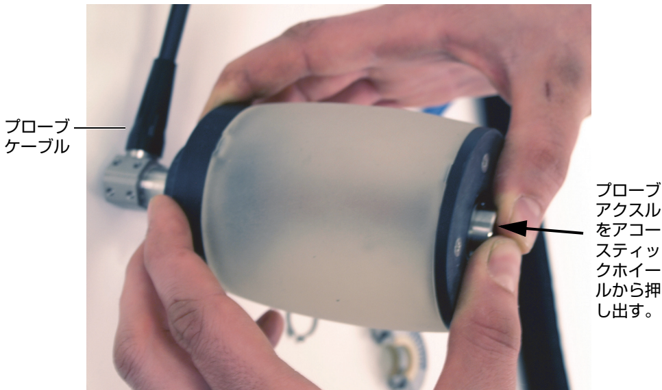
図 6-8 プローブアクスルをアコースティックホイールから押し出し
