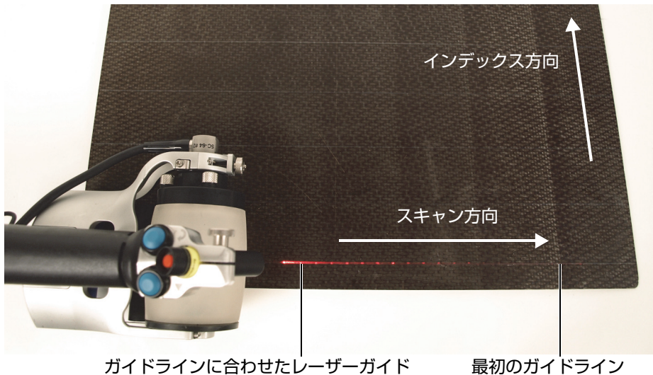
図 5-4 最初のガイドラインに RollerFORM の位置を合わせる
