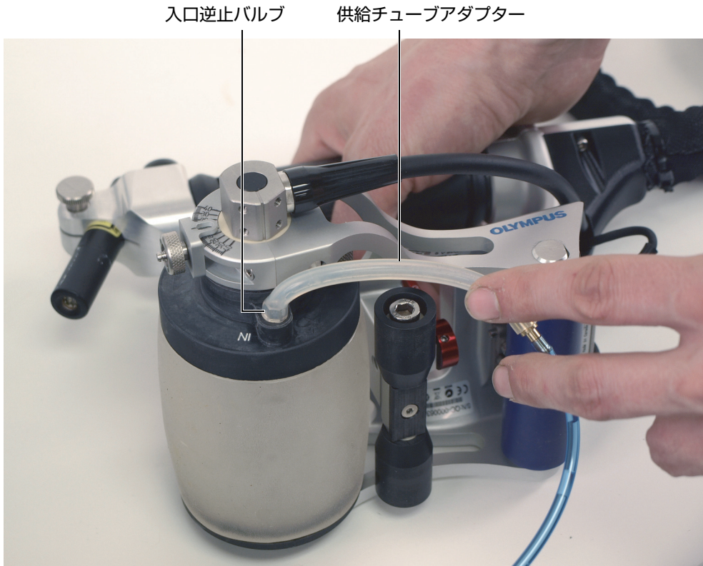
図 3-2 供給チューブアダプターを入口逆止バルブに接続
