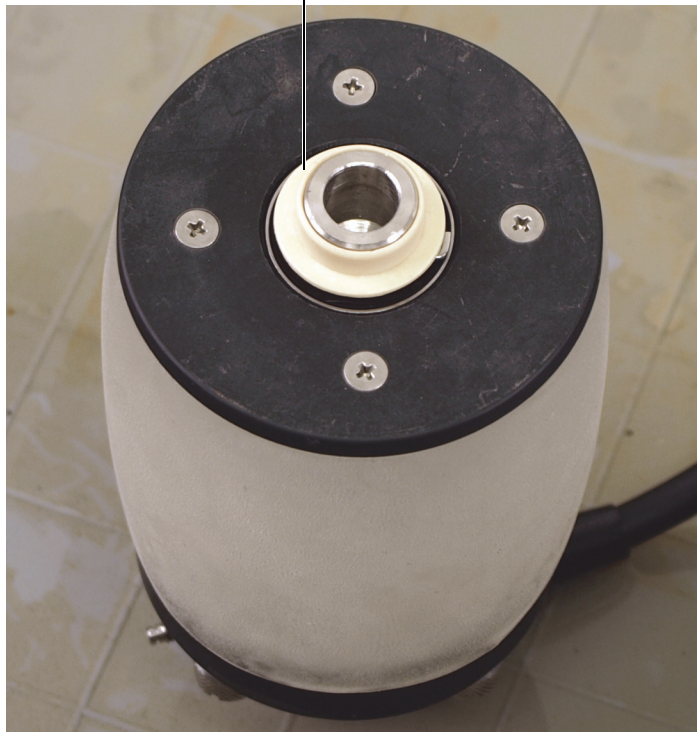
図 6-6 プローブアクスルの端からブッシングの取り外し（XL モデル以外のみ）
