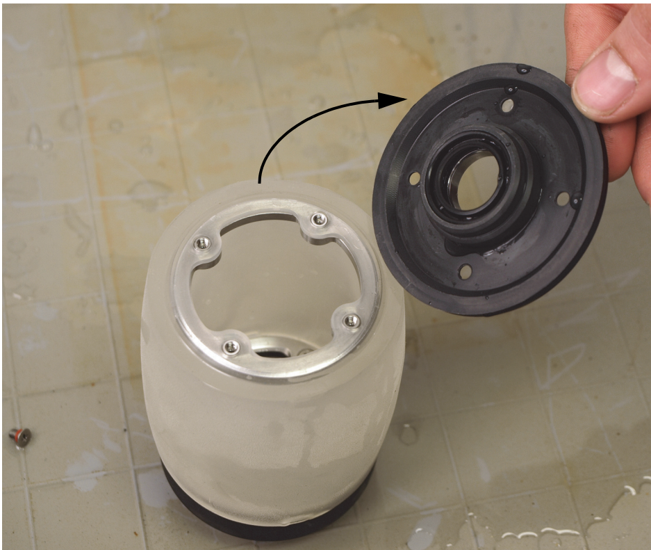
図 6-17 アコースティックホイールプレーンフランジの取り外し
