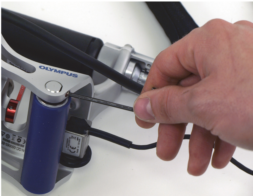
図 6-33 後部ローラーの止ネジを緩める
