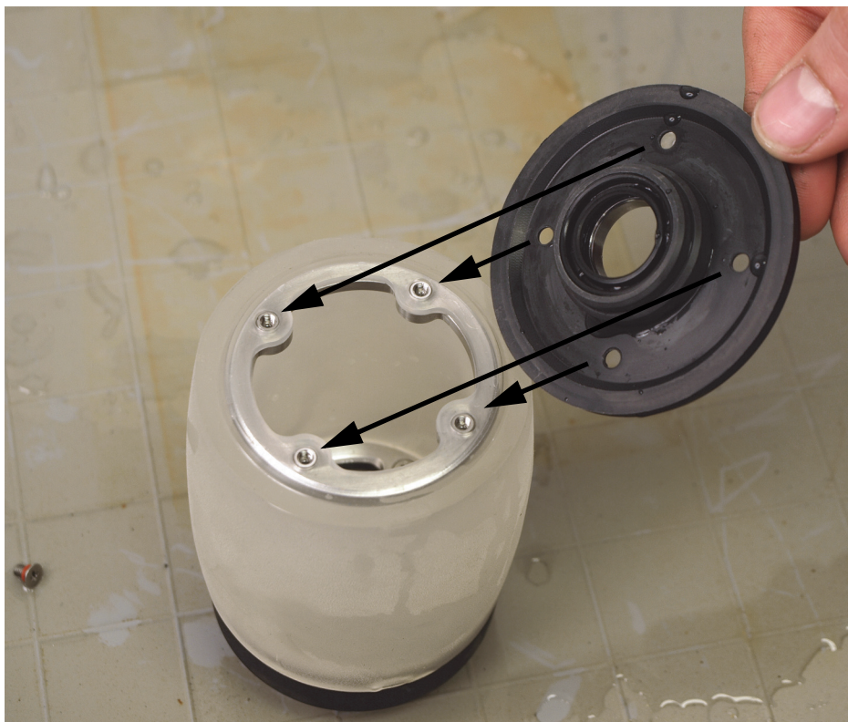
図 6-28 プレーンフランジの取り付け
