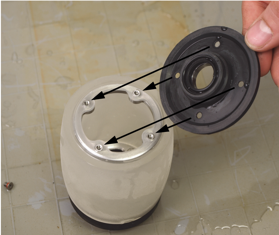
図 6-16 プレーンフランジの取り付け
