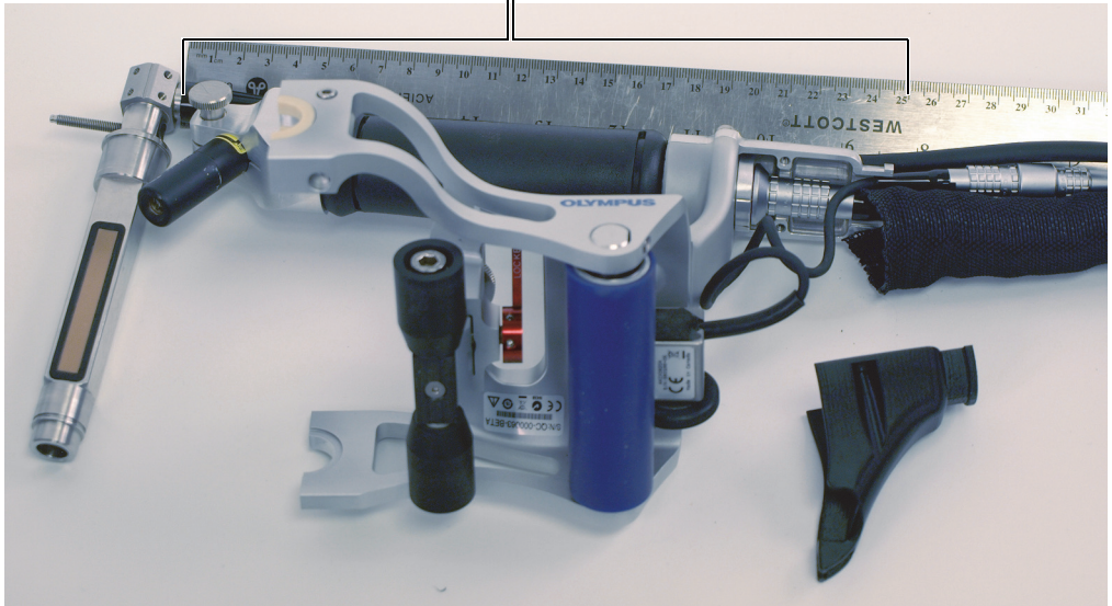
図 6-13 RollerFORM ハンドルの前端から後端まで伸びたプローブケーブル
