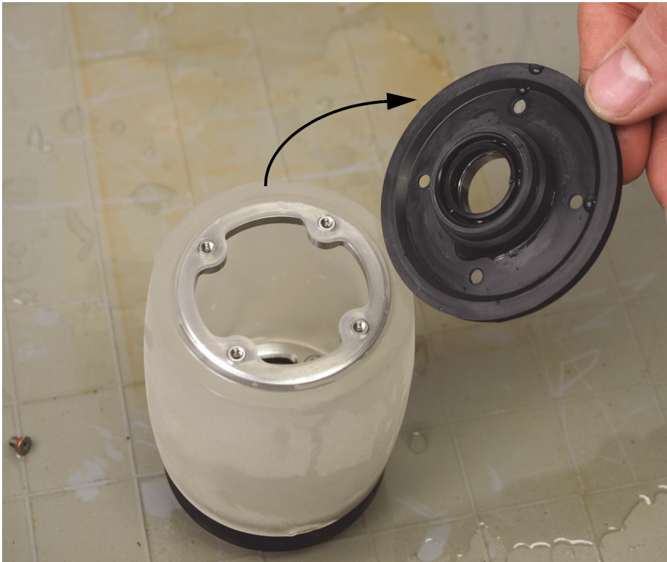
Rysunek 6-20 Wymontowywanie prostego kołnierza koła akustycznego
