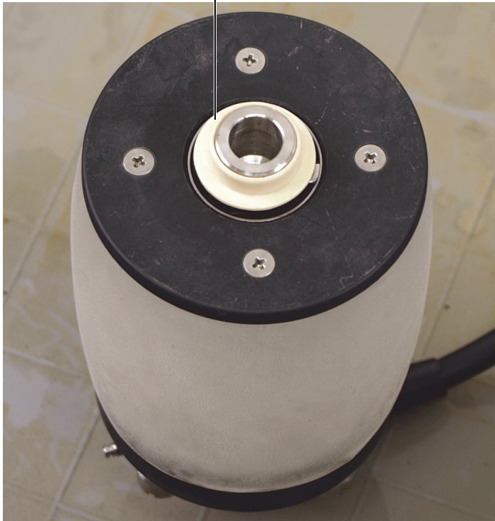
Rysunek 6-6 Zdejmowanie tulei z końca osi z sondą (nie dotyczy modeli XL)
