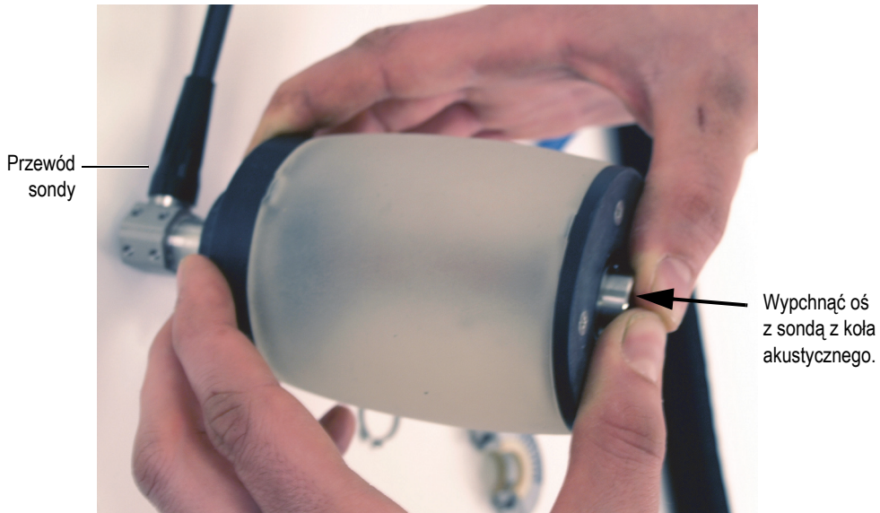
Rysunek 6-8 Wypychanie osi z sondą z koła akustycznego
