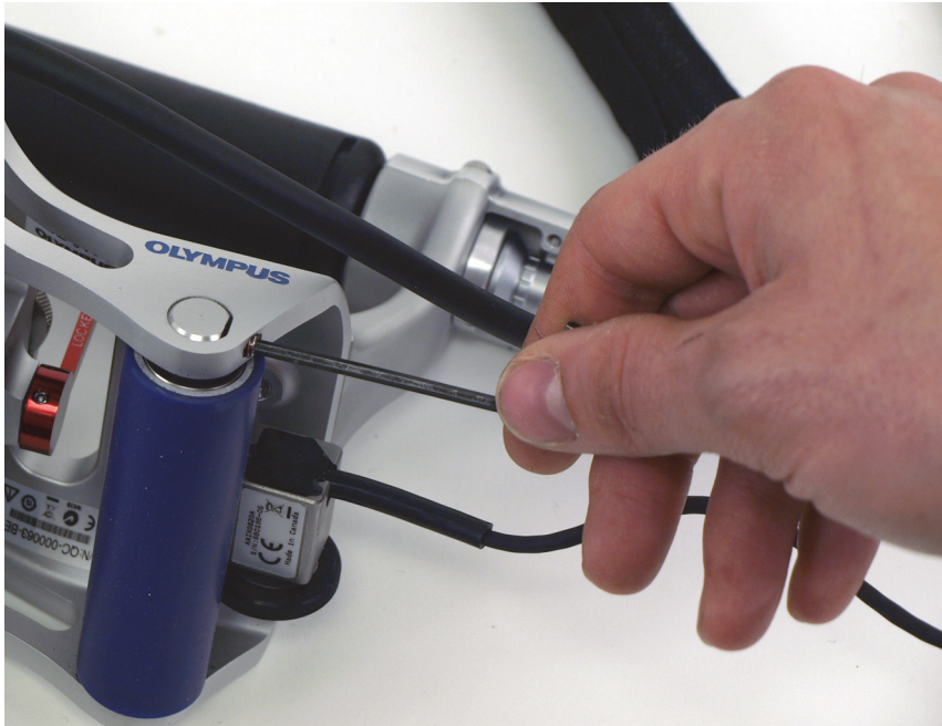
Rysunek 6-33 Luzowanie śruby ustalającej tylną rolkę
