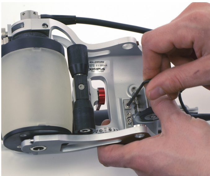
Rysunek 6-36 Luzowanie śruby ustalającej enkoder
