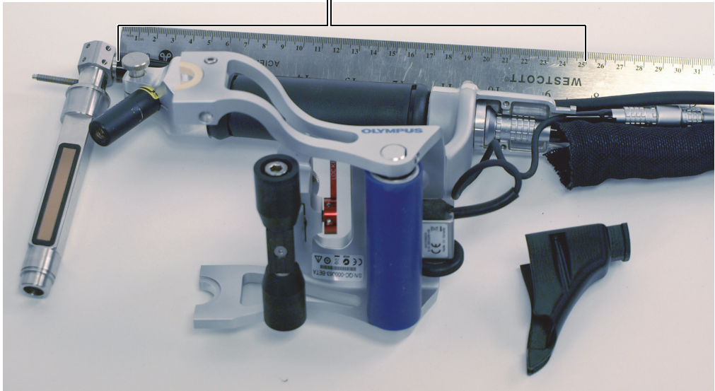
Rysunek 6-13 Przewód sondy przebiegający od przedniego do tylnego końca rękojści skanera RollerFORM
