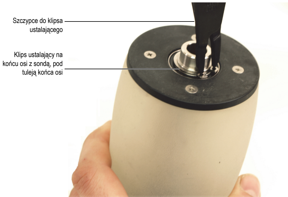
Rysunek 6-7 Zdejmowanie zewnętrznego klipsa ustalającego z końca osi z sondą
