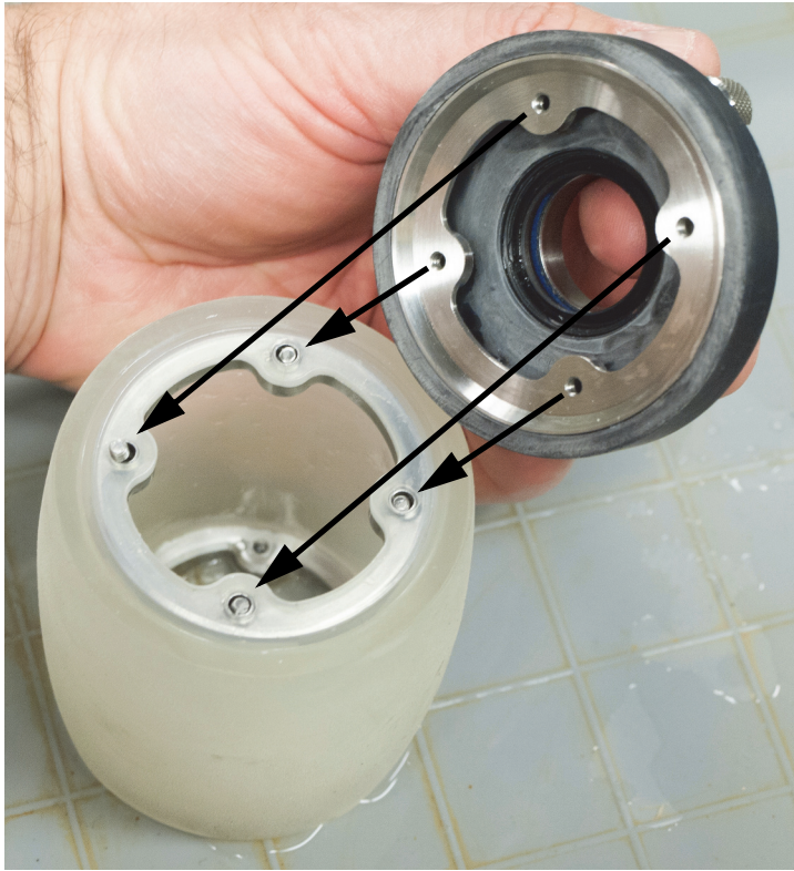
Rysunek 6-26 Montaż kołnierza zawierającego zawory sterujące przepływem cieczy
