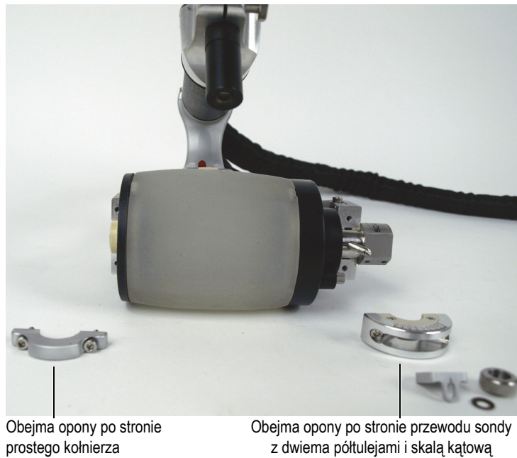
Rysunek 6-2 Demontowanie obejm mocujących koło akustyczne
