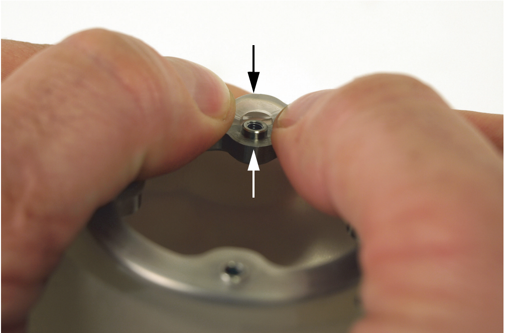
Rysunek 6-25 Wkładanie pierścienia do rowka ustalającego w oponie
