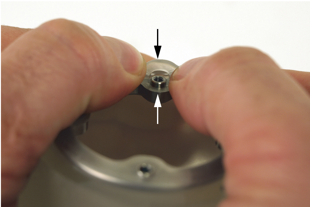
Figura 6-25 Instalação do anel no sulco de retenção no pneu
