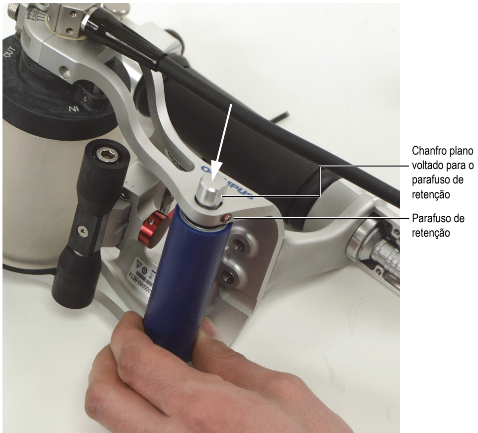
Figura 6-38 Alinhamento do chanfro plano da extremidade do eixo do rolo traseiro com o parafuso de retenção
