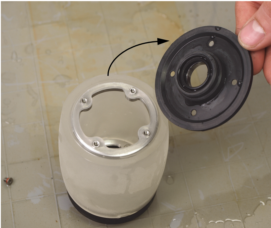
Figura 6-17 Remoção do flange plano da roda acústica
