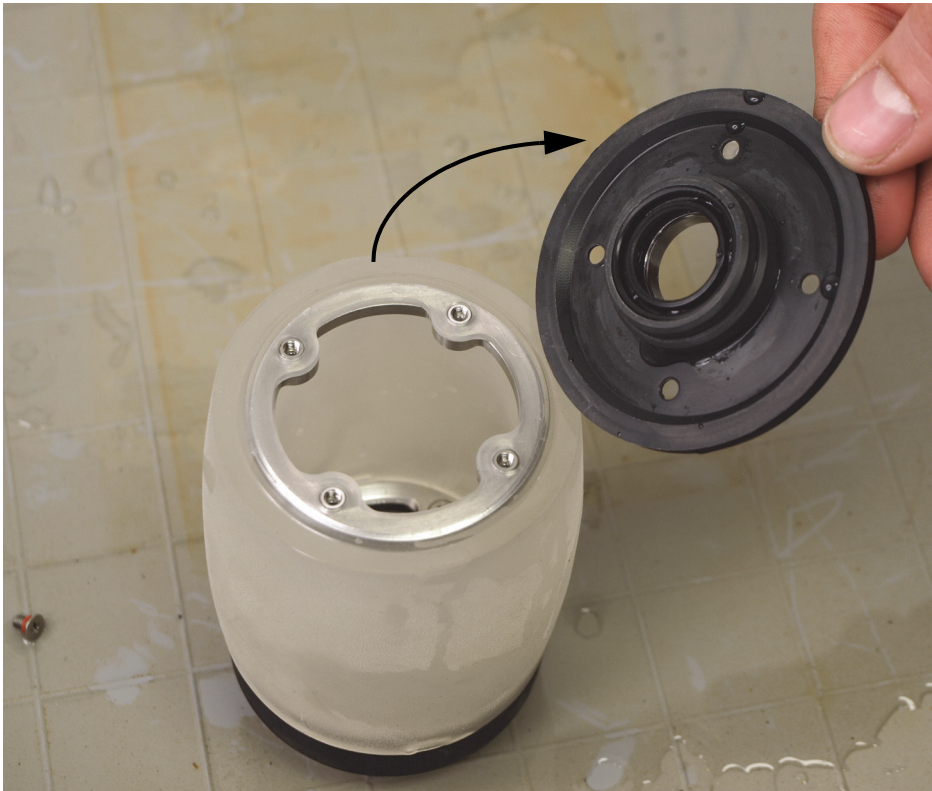
Figura 6-20 Remoção do flange plano da roda acústica
