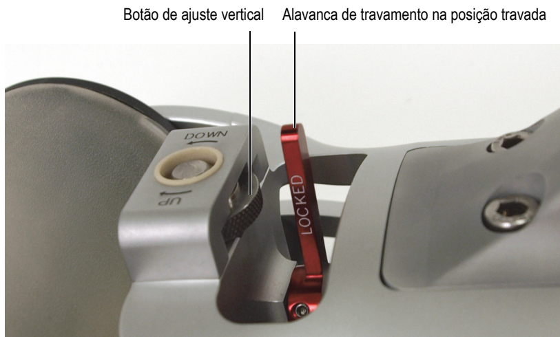
Figura 4-3 Roda do meio travada
