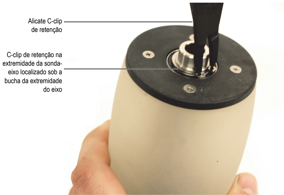
Figura 6-7 Remoção do C-clip de retenção externo da extremidade da sonda-eixo
