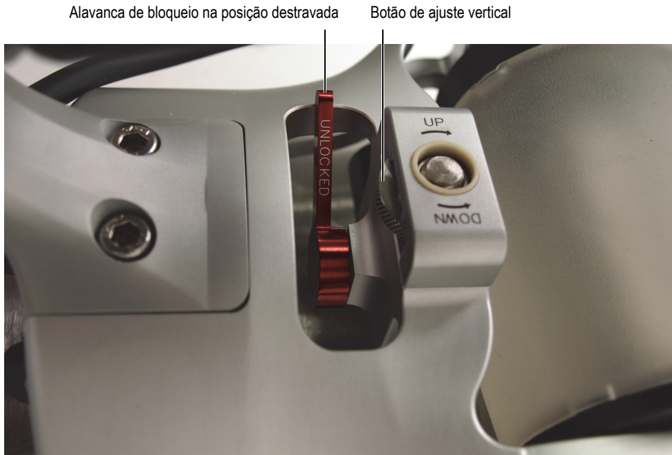
Figura 4-5 Roda do meio destravada
