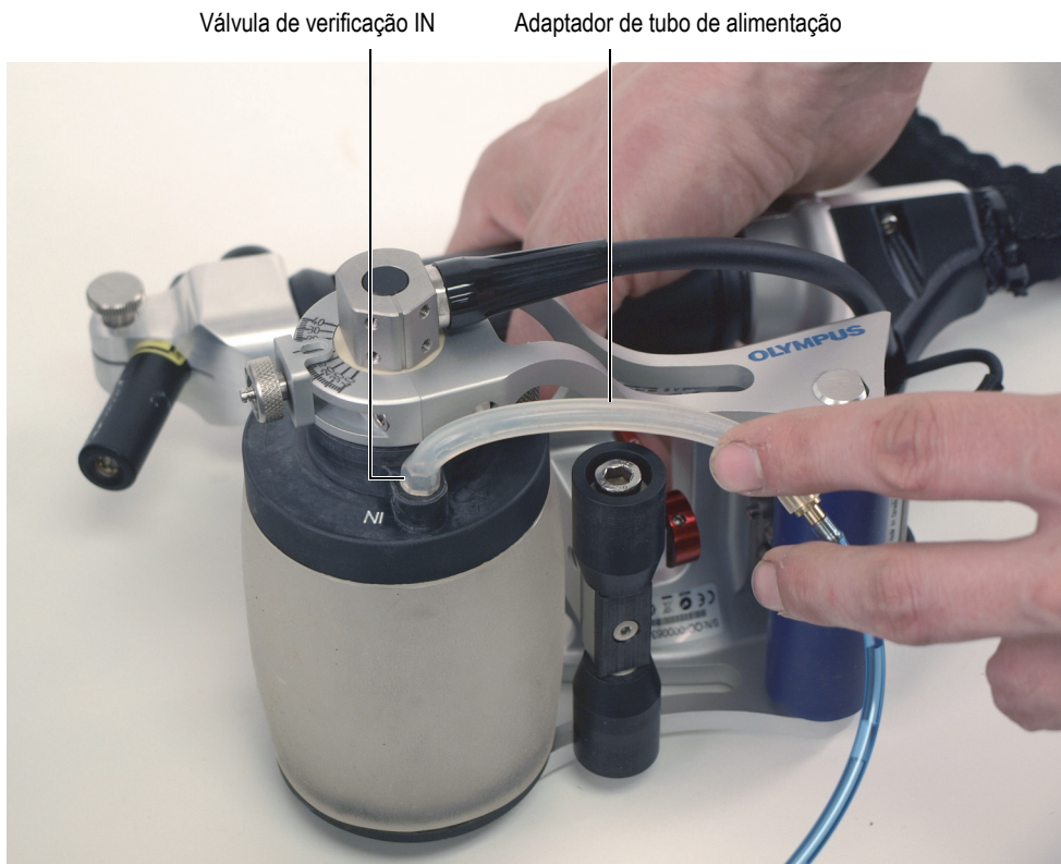
Figura 3-2 Conectar o adaptador do tubo de alimentação à válvula de retenção IN
