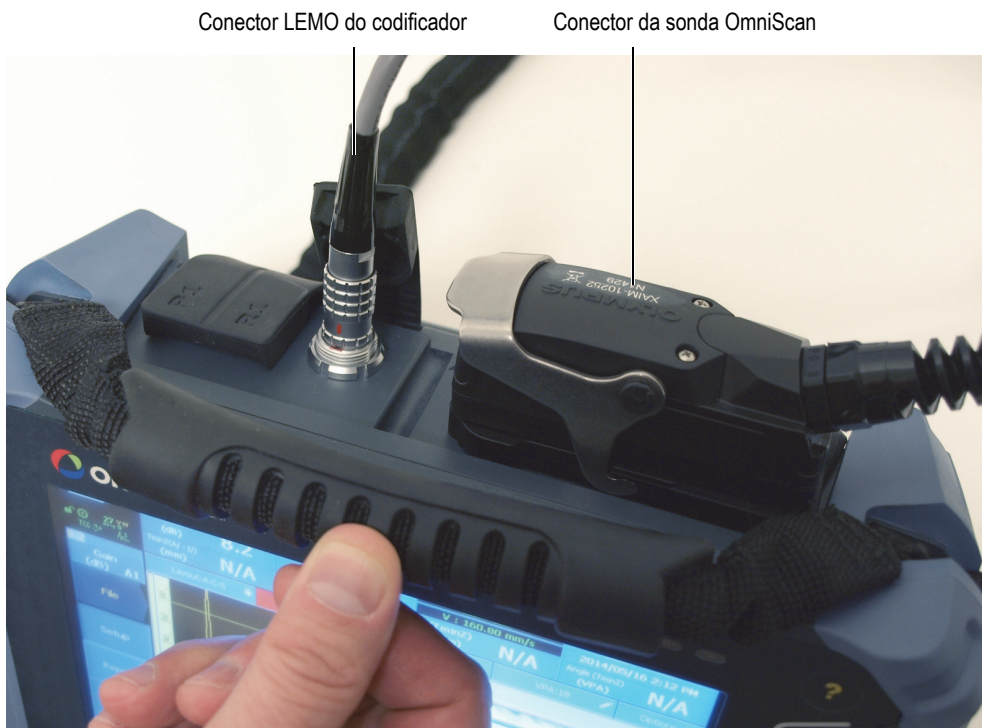
Figura 2-1 Instrumento OmniScan com cabos conectados ao RollerFORM
