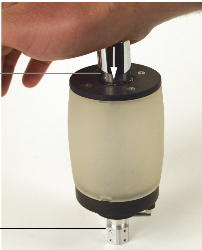
Figura 6-11 Pressione o C-clip no sulco na extremidade da sonda-eixo com a ferramenta de instalação do C-clip
