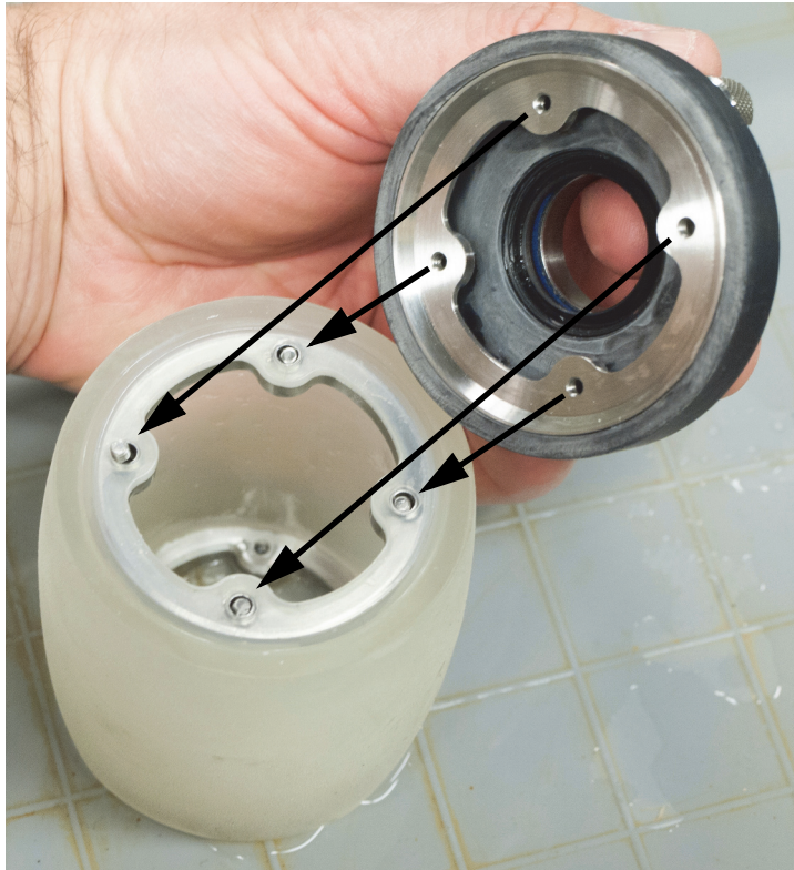
Figura 6-26 Instalação o flange com as válvulas de controle de líquido
