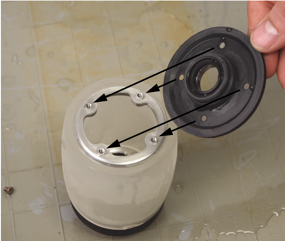
Figura 6-16 Instalação do flange plano
