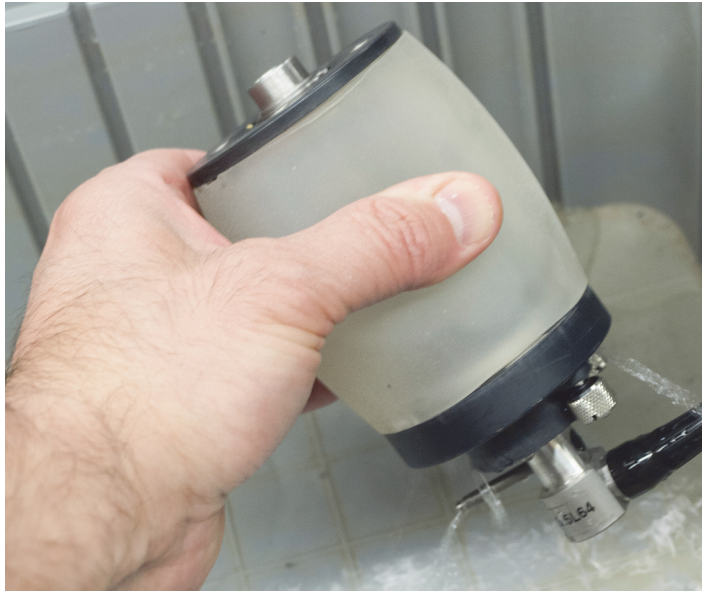
Figura 6-5 Drenagem da câmara de líquido
