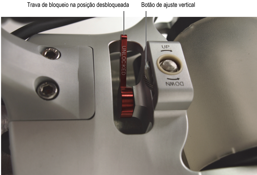
Figura 4-4 Roda do meio destravada
