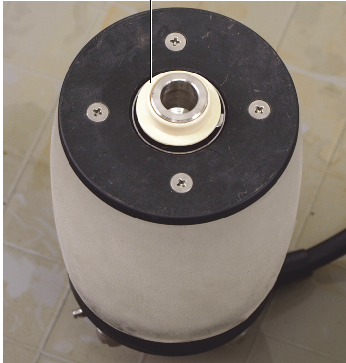
Figura 6-6 Remoção da bucha da extremidade da sonda-eixo (não para os modelos XL)
