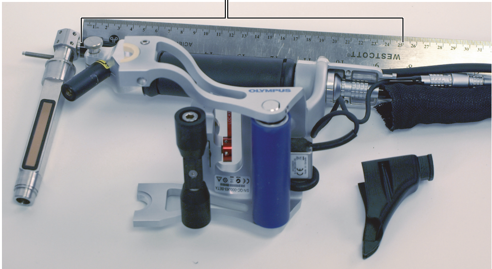
Figura 6-13 Cabo da sonda estendendo-se da frente até a extremidade traseira da pega do RollerFORM
