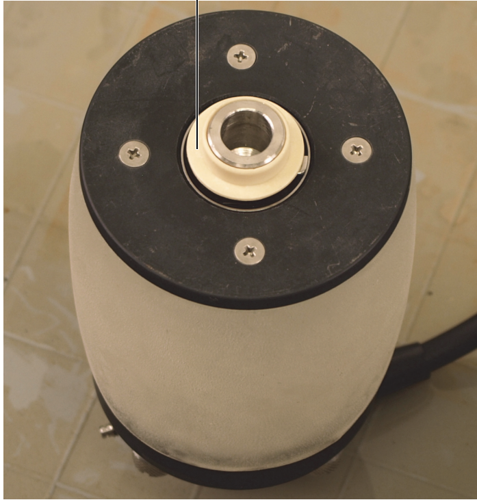
Figura 6-30 Instalação da bucha na extremidade da sonda-eixo (não no modelo XL)
