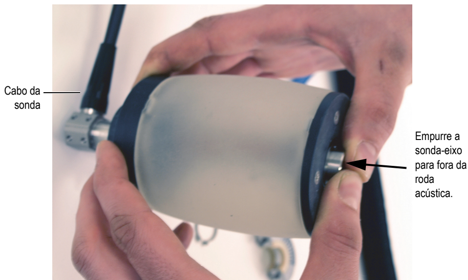
Figura 6-8 Empurre a sonda-eixo para fora da roda acústica
