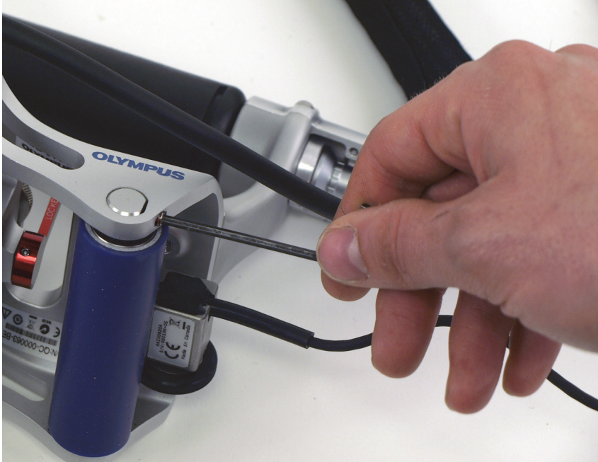
Figura 6-33 Soltar o parafuso de retenção do rolo traseiro
