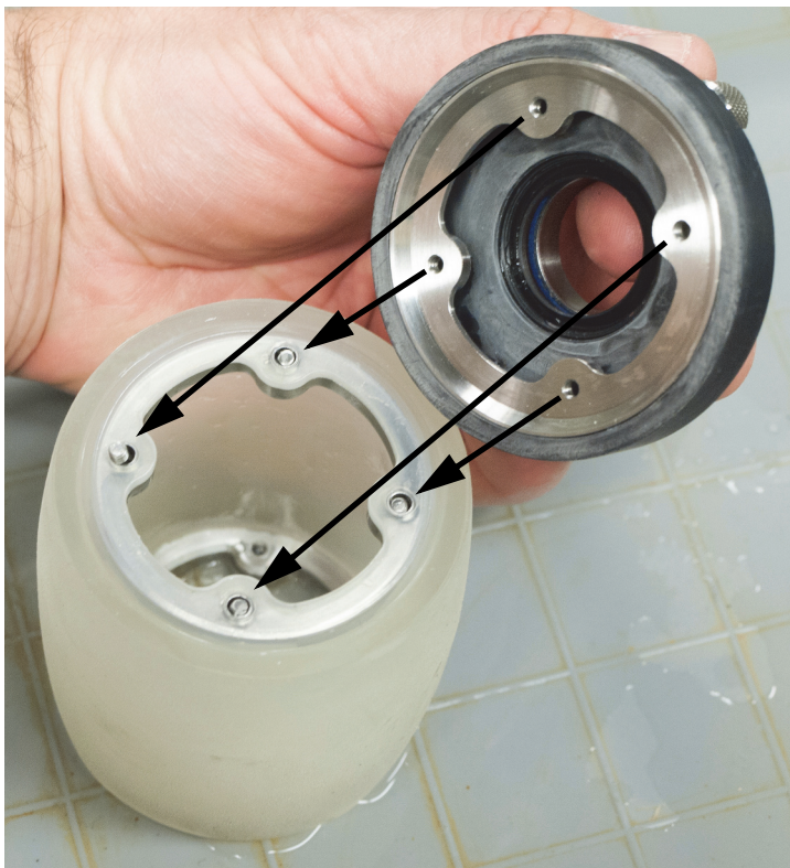
Рис. 6-26 Установка фланца с контрольными клапанами
