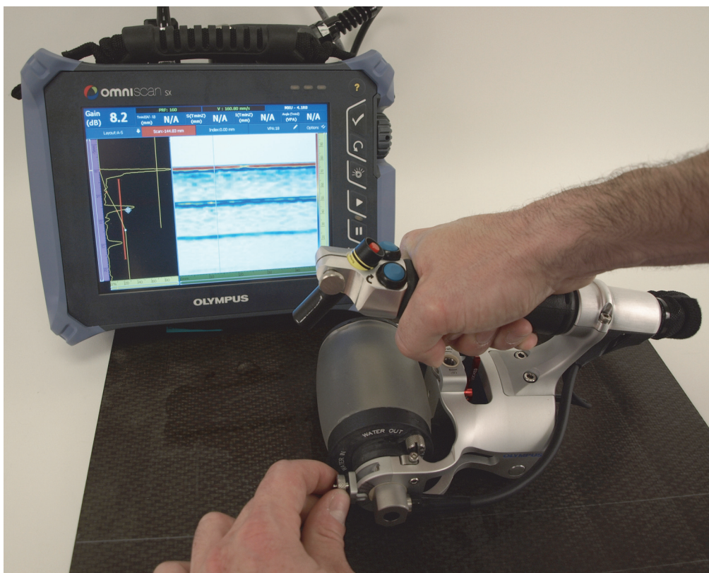
Рис. 4-1 Настройка угла преобразователя для оптимизации сигнала
