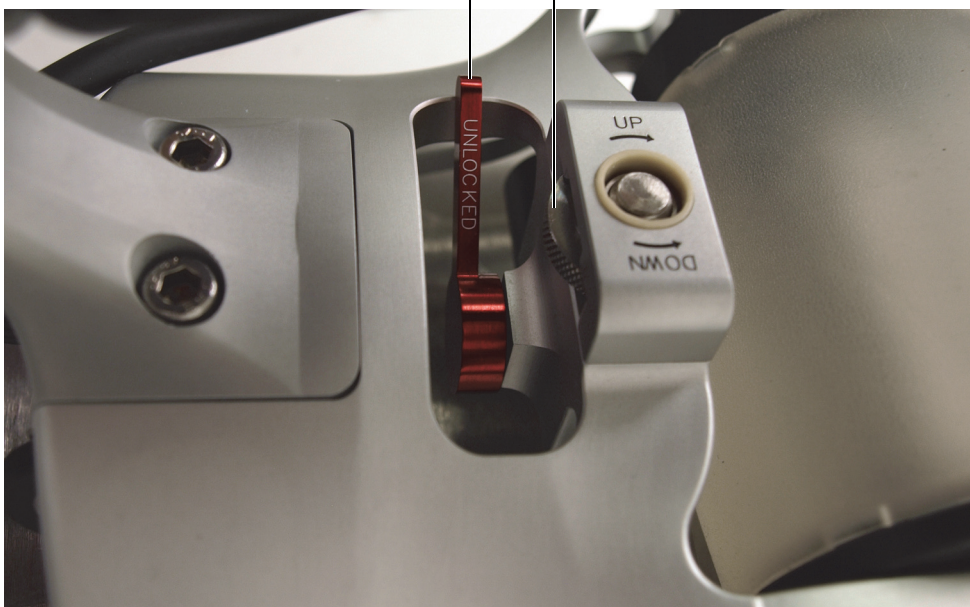
Рис. 4-2 Разблокировка среднего колеса
