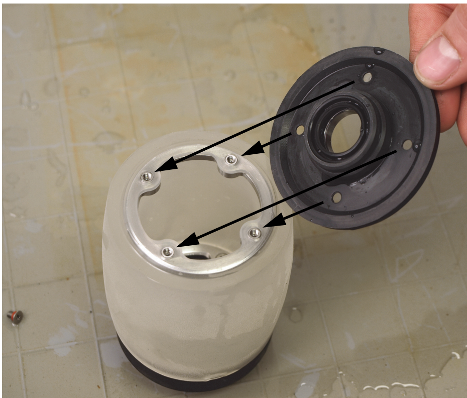
Рис. 6-16 Установка плоского фланца
