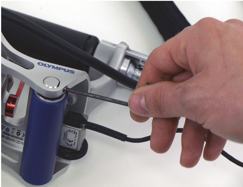
Рис. 6-33 Ослабление крепежного винта заднего ролика
