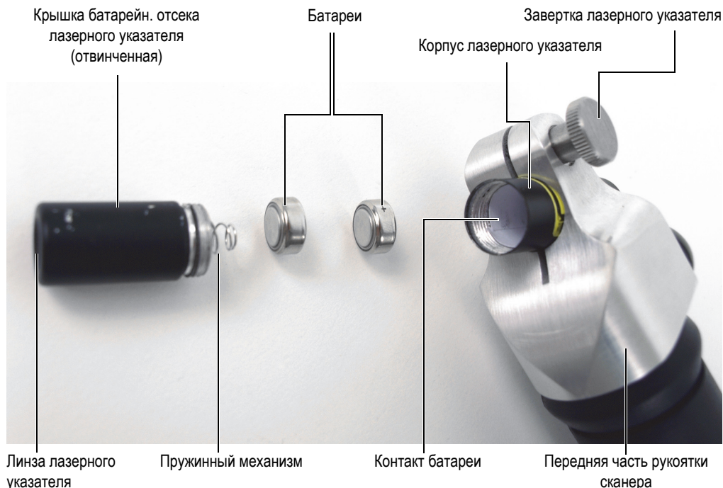
Рис. 6-42 Замена батарей лазерного указателя
