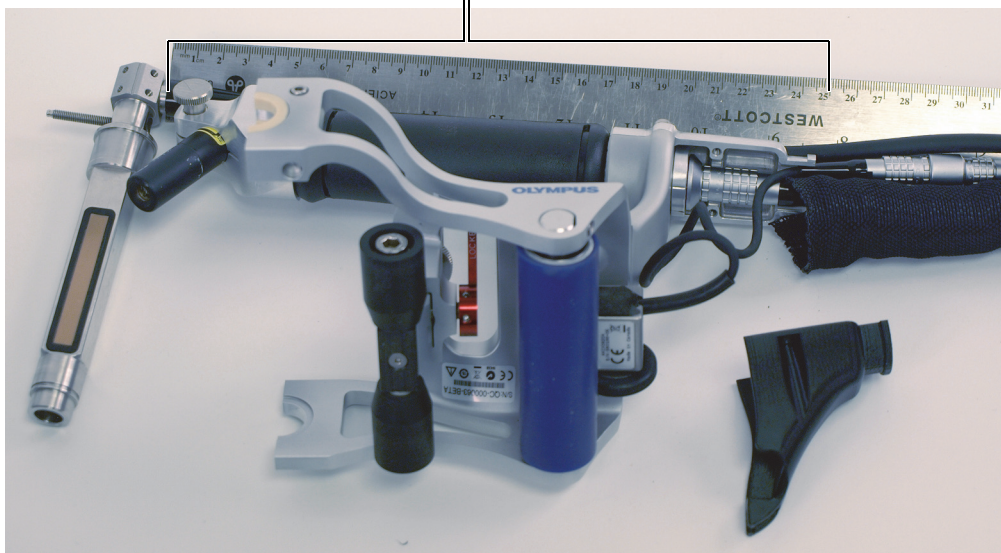
Рис. 6-13 Кабель преобразователя, протянутый вдоль рукоятки RollerFORM
