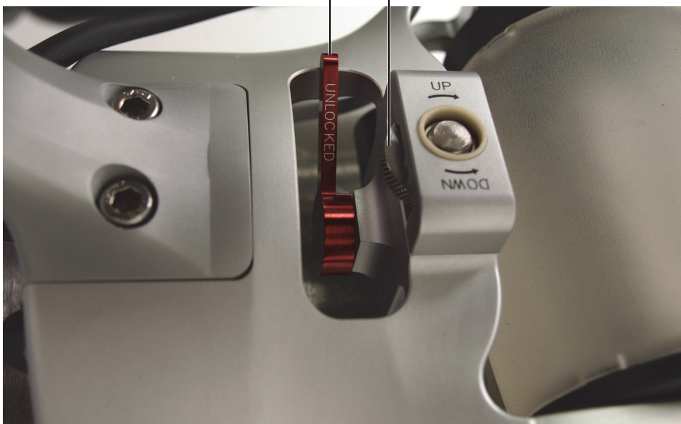
Рис. 4-4 Разблокировка среднего колеса
