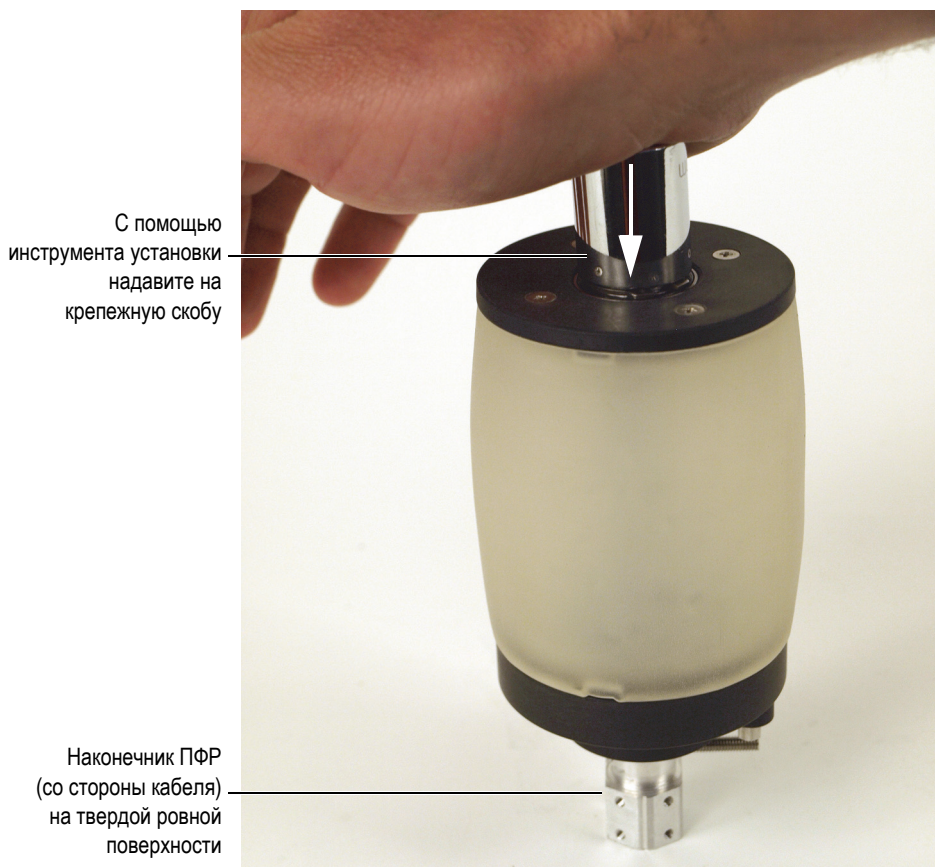
Рис. 6-11 Установка крепежной скобы на наконечник оси-преобразователя
