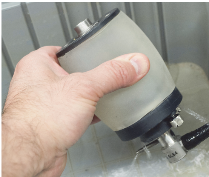
Рис. 6-5 Опорожнение резервуара колеса
