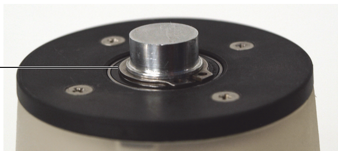
Рис. 6-12 Установка крепежной скобы на наконечник оси-преобразователя
