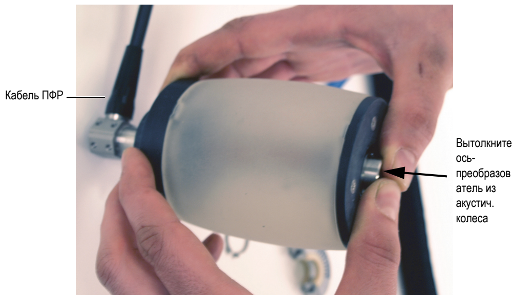
Рис. 6-8 Извлечение оси-преобразователя из акустического колеса
