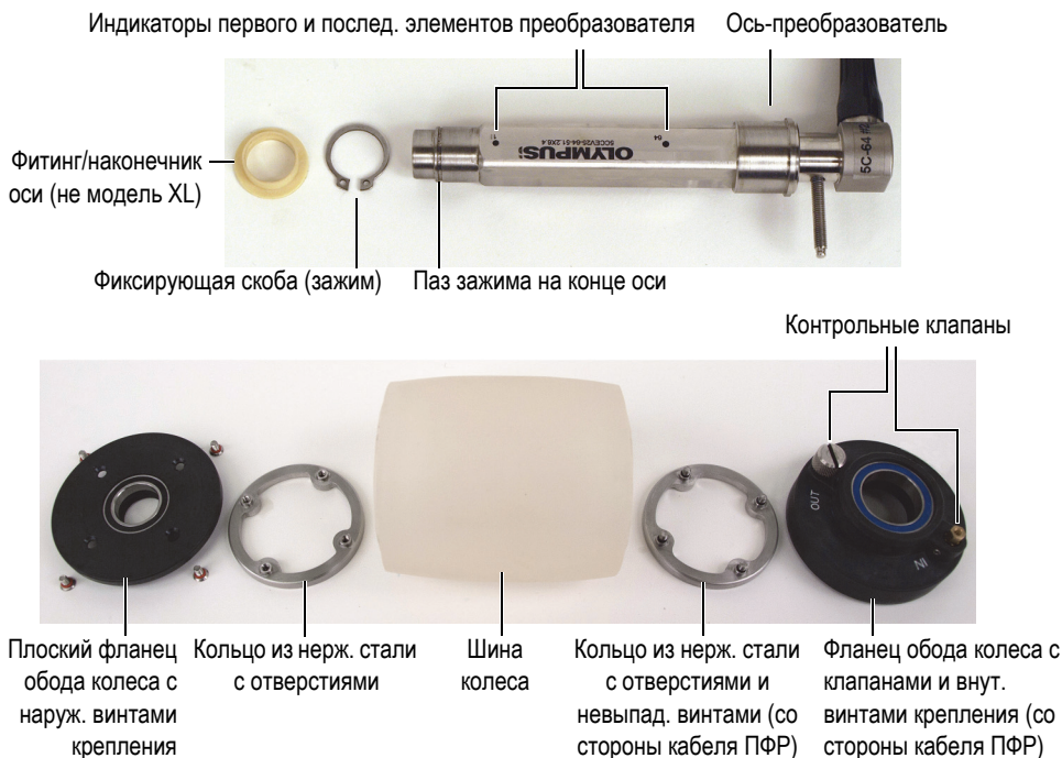
Рис. 1-3 Компоненты акустического колеса
