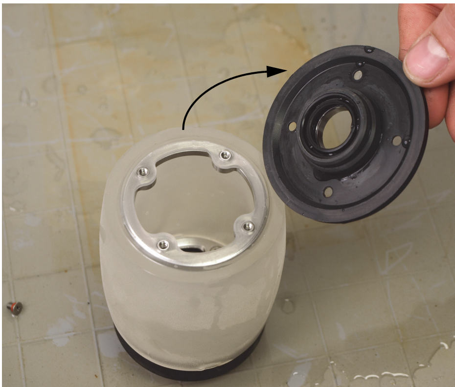
Рис. 6-20 Снятие плоского фланца акустического колеса
