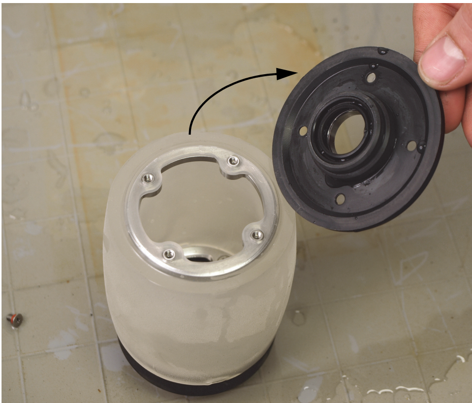
Рис. 6-17 Снятие плоского фланца акустического колеса
