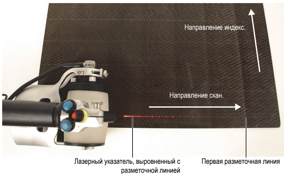
Рис. 5-4 Расположение RollerFORM по первой разметочной линии
