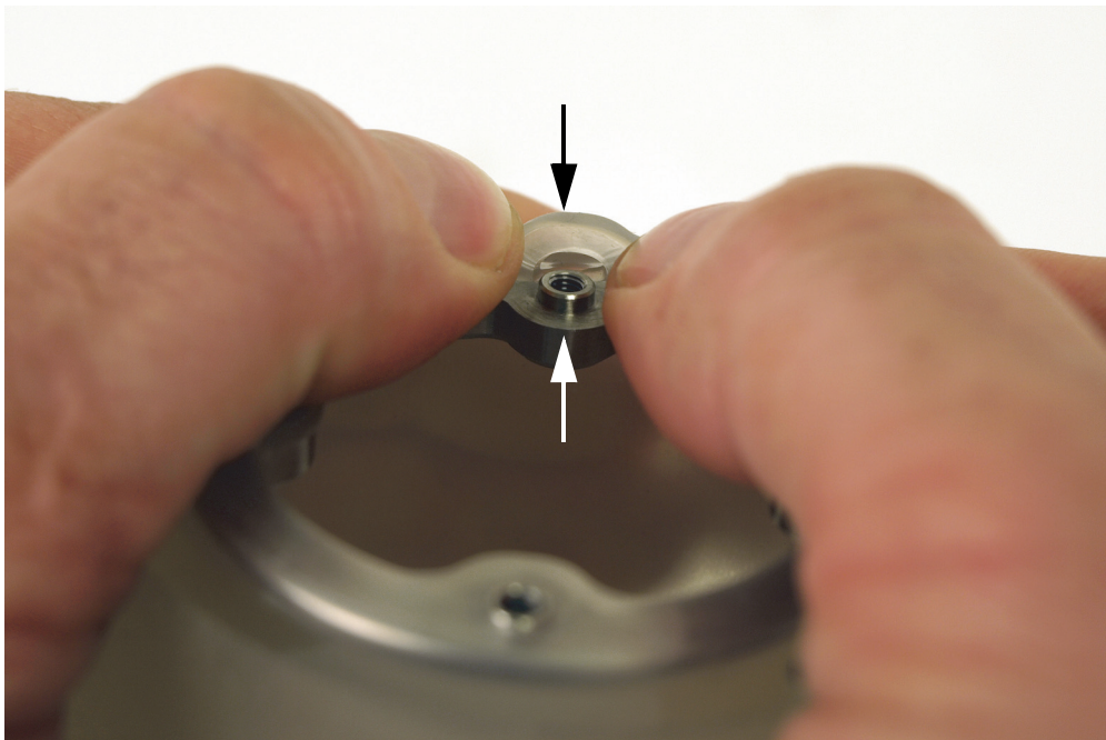
Рис. 6-25 Установка кольца в гнездо шины
