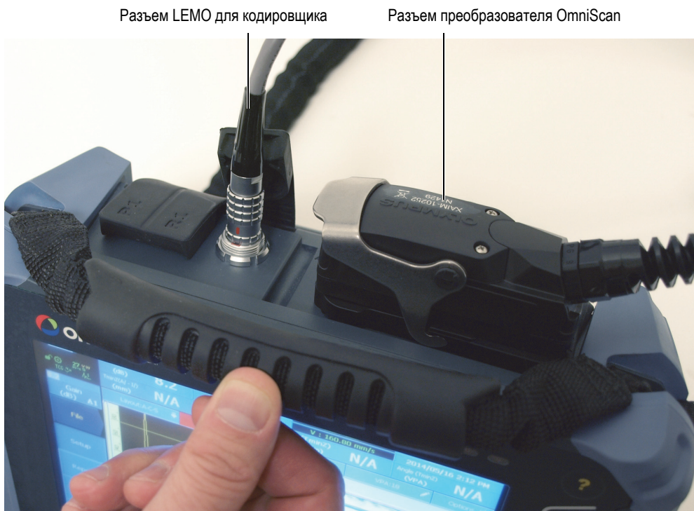
Рис. 2-1 Прибор OmniScan с подключенными кабелями RollerFORM
