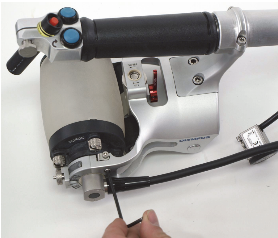
Рис. 6-39 Ослабление винта альтернативного держателя кодировщика
