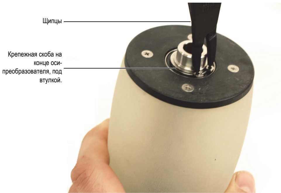
Рис. 6-7 Снятие крепежной скобы с наконечника оси-преобразователя
