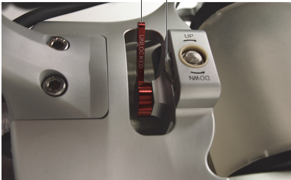
Рис. 4-5 Разблокировка среднего колеса
