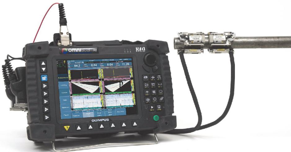
Abbildung 1 OmniScan MX und COBRA-Scanner
