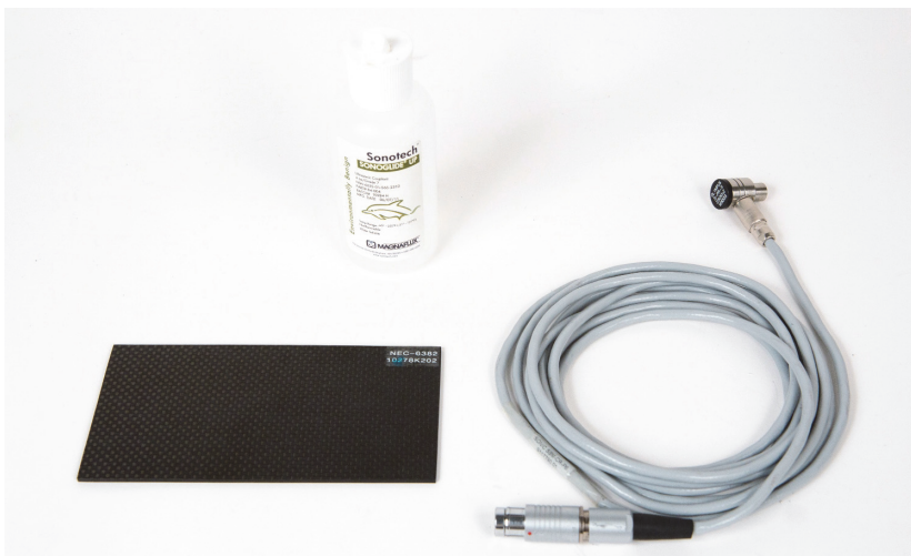
Obrázek 6-45 Materiály – kontrola delaminace v kompozitech s využitím metody rezonance
