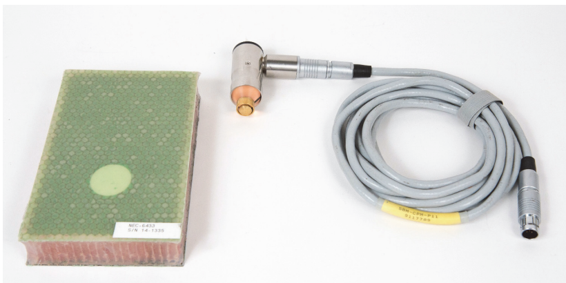
Obrázek 6-29 Materiály – opravené oblasti (zalité) pomocí metody MIA
