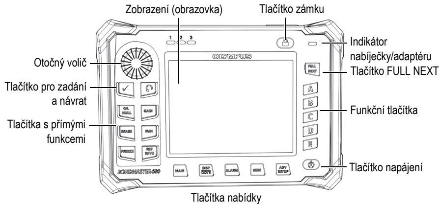
Obrázek 2-15 Čelní panel přístroje BondMaster 600 s otočným voličem a klávesnicí
