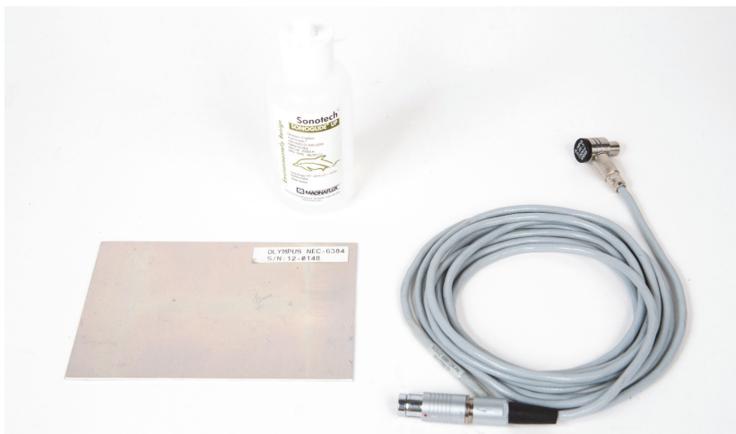
Obrázek 6-37 Materiály – Kontrola vazeb mezi kovy s metodou rezonance
