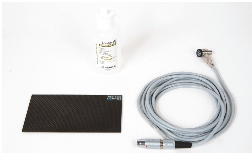
Figure 6-45 Matériaux — Délamination des matériaux composites à l'aide de la technique d'inspection résonance
