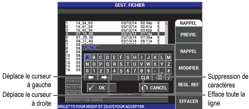
Figure 5-23 Mémoire de l'éditeur de texte du menu GEST. FICHER et touches spéciales
