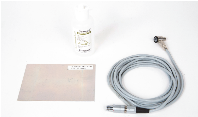
Figura 6-37 Materiali — Perdite di adesione metallo su metallo mediante la tecnica a risonanza
