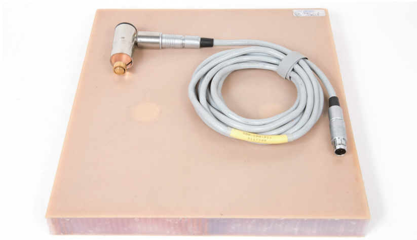
Figura 6-61 Materiali – Individuazione della migliore frequenza mediante la tecnica MIA
