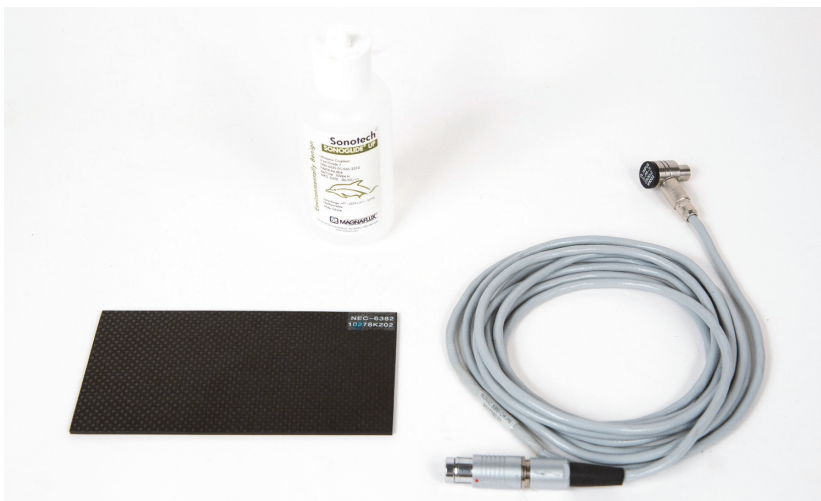
Rysunek 6-45 Materiały — delaminacja w kompozytach z zastosowaniem techniki rezonansu
