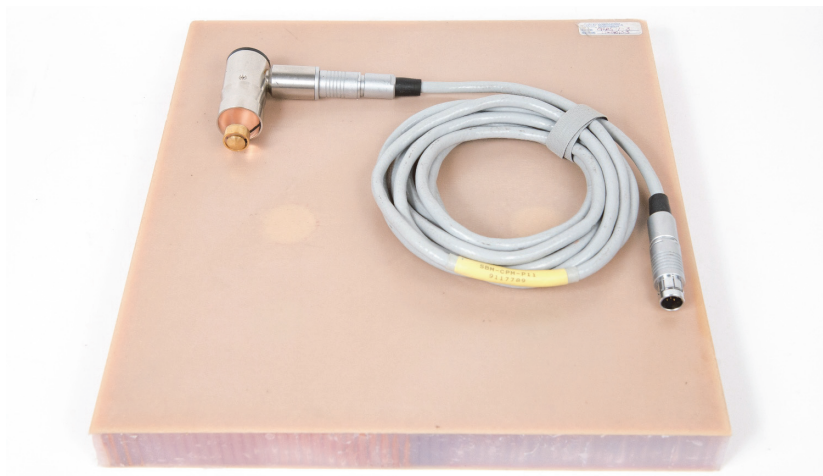
Rysunek 6-61 Materiały – znajdowanie optymalnej częstotliwości za pomocą techniki MIA
