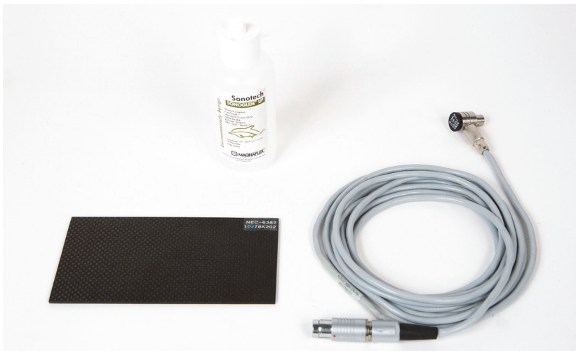
图 6-45 材料 — 使用谐振技术探测复合材料中的分层缺陷
