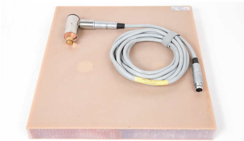
图 6-61 材料 — 找到使用机械阻抗分析技术时的最佳频率
