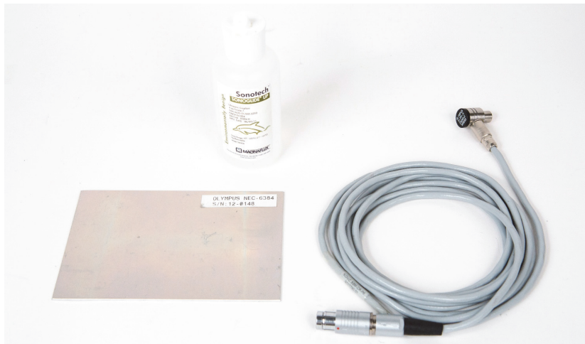
图 6-37 材料 — 使用谐振技术探测金属与金属脱粘缺陷
