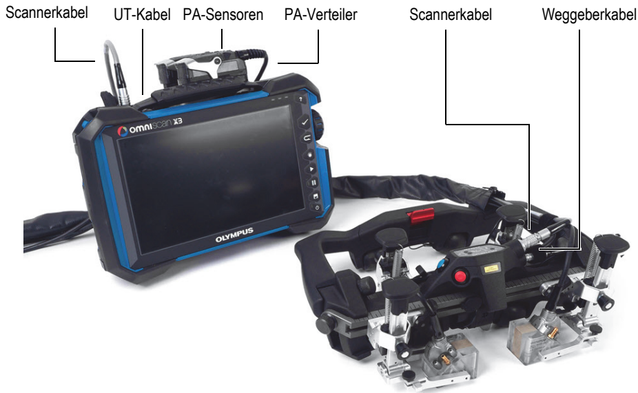
Abbildung 2-28 Scanner und OmniScan verbunden
