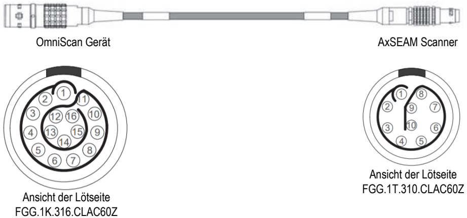
Abbildung 7-5 Kontaktstiftbelegungen für die Kabelanschlüsse zwischen Scanner und OmniScan
