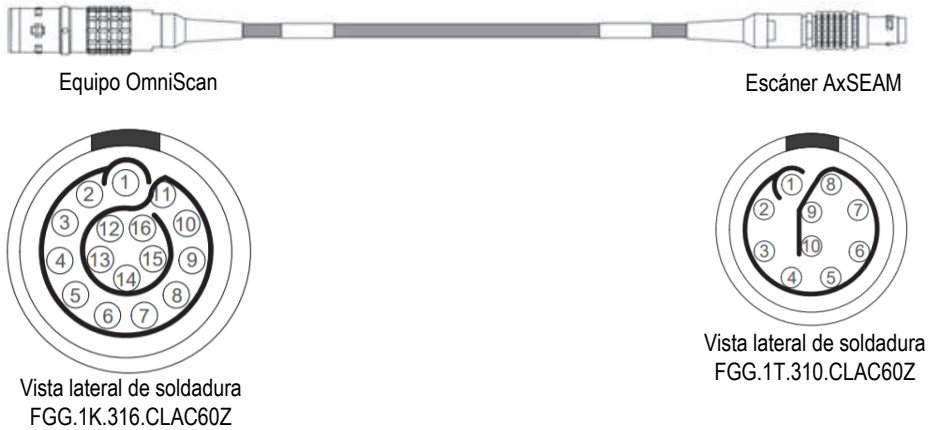
Figura 7-5 Asignación de pines para los conectores del cable destinado a conectar el escáner al OmniScan
