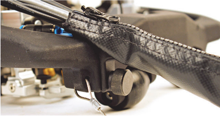
Figura 2-27 Control de cableado: cremallera
