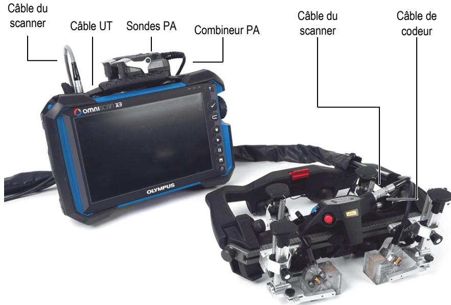
Figure 2-28 Connexion du scanner et de l'OmniScan
