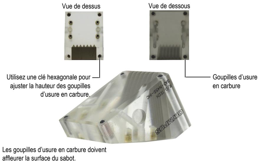
**Figure 2-17 Réglage des goupilles d'usure en carbure du sabot**
