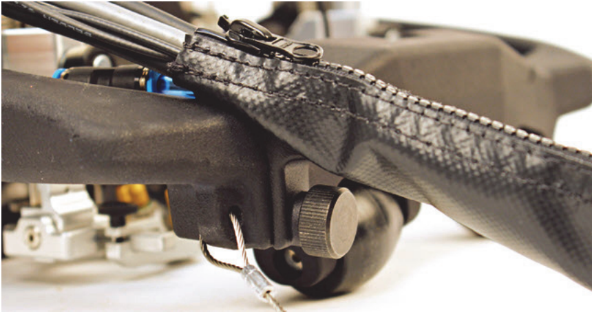
Figura 2-27 Cablaggio: guaina con cerniera
