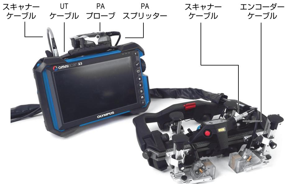
図 2-28 スキャナーと OmniScan が接続されている状態
