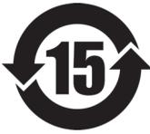
中国 RoHS マークは、製品の環境保護使用期限（EFUP）を示しています。EFUP マーク内の数字は、規制物質として一覧に取り上げられている物質が漏出したり、化学的に劣化することがないとされる年数を示しています。AxSEAM の EFUP は、15 年とされています。
