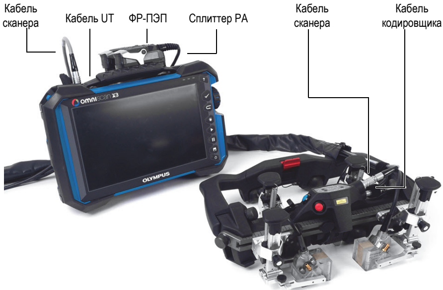
Рис. 2-28 Сканер, подключенный к OmniScan
