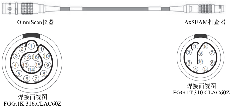
图 7-5 连接扫查器和OmniScan仪器的线缆连接器的引脚编号示意图
