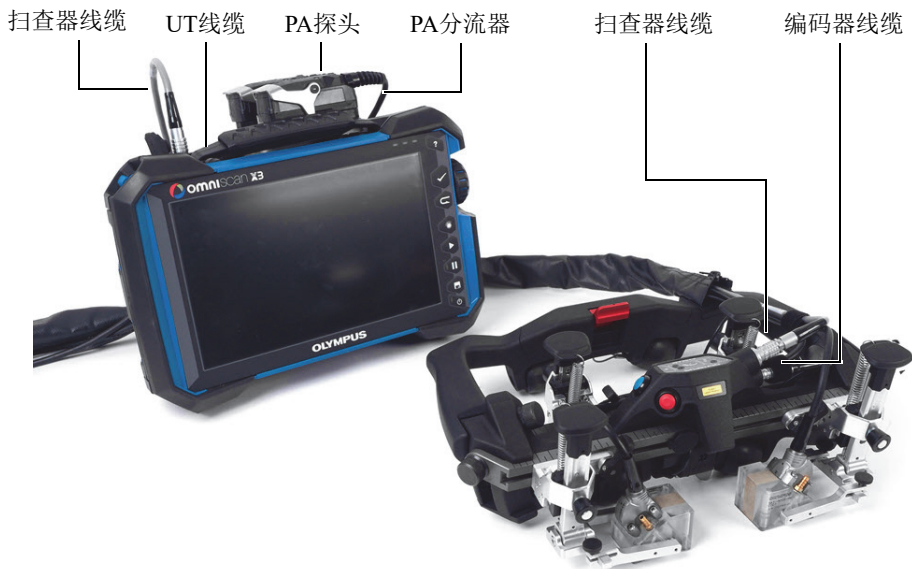
图 2-28 扫查器与OmniScan连接在一起
