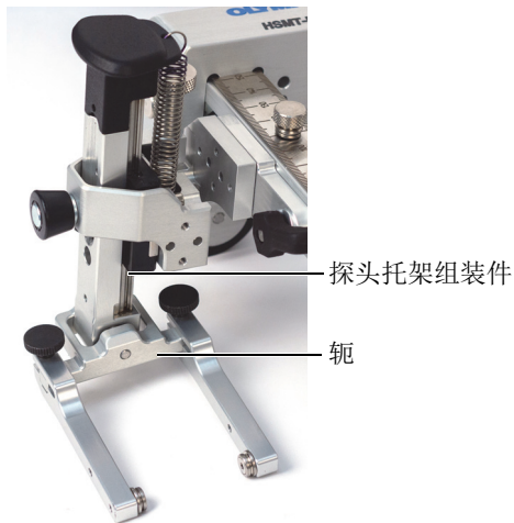
图 2-3 轭垂直于探头托架
