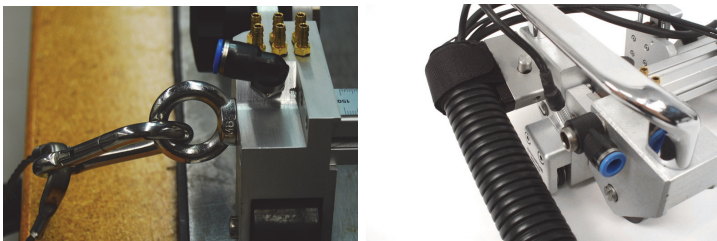
图 3-1 将脐带电缆连接到连接环上
