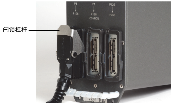
图 A-3 相控阵 — 新型连接器闩锁杠杆
