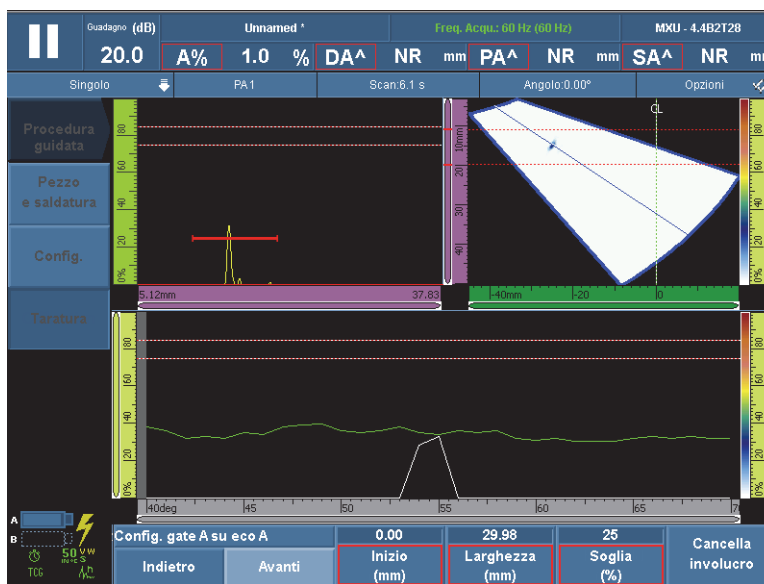
Figura 5-21 Configurare il gate A sull'eco per un gruppo PA
