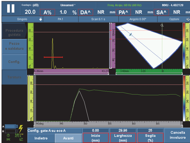
Figura 5-19 Configurare il gate A sull'eco per un gruppo PA
