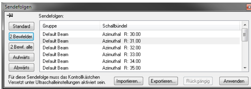
Abbildung 4-63 Sendefolge mit versetzten Schallbündelpaaren in jeder Gruppe (Beispiel)
