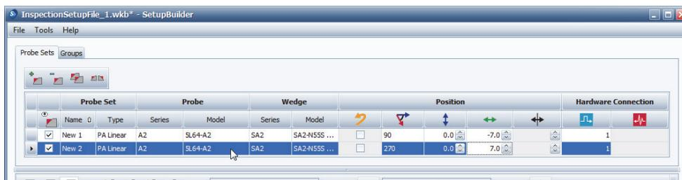
Рис. 9-6 Выбор ПЭП-призмы во вкладке Probe Sets для конфигурации параметров
