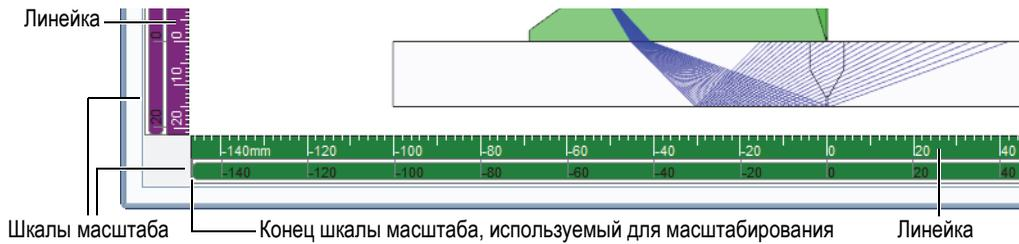
**Рис. 4-14 Компоненты оси области отображения RayTracing**
