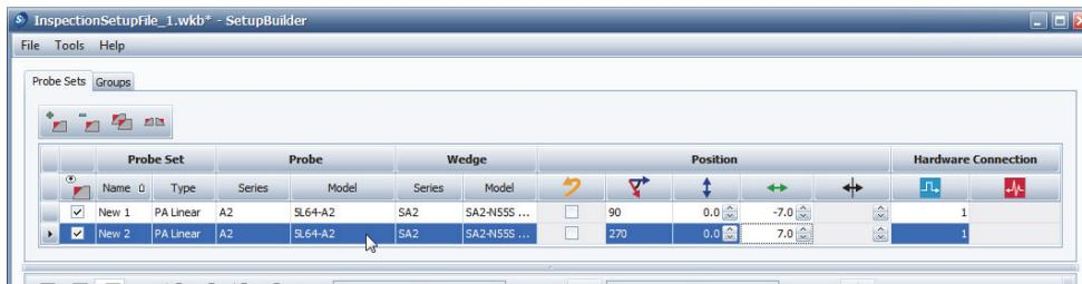
Рис. 9-4 Выбор ПЭП-призмы во вкладке **Probe Sets** для зеркального отображения
