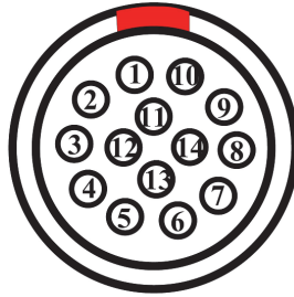
Figura 6-2 Conector LEMO de alarma y E/S (vista de contacto)
