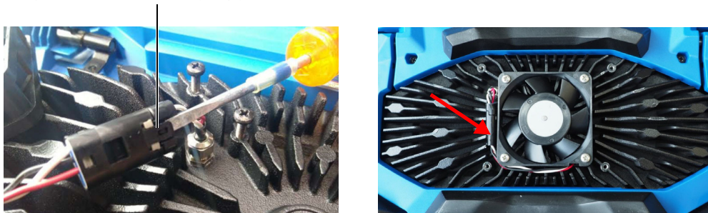
図 4-3 ファンケーブルの取り外し (左) と最終的な位置 (右)
