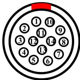
図 6-2 アラームおよび入出力 LEMO コネクタ（接触面）
