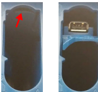
Rysunek 2-3 Nacisnąć osłonę (po lewej stronie) i wysunąć ukryty port USB 2.0 (po prawej stronie)
