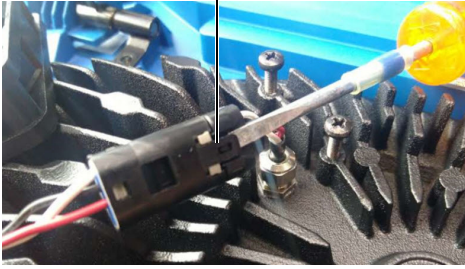
Rysunek 4-3 Odłączenie przewodu wentylatora (po lewej stronie) i ostateczne umiejscowienie (po prawej stronie)
