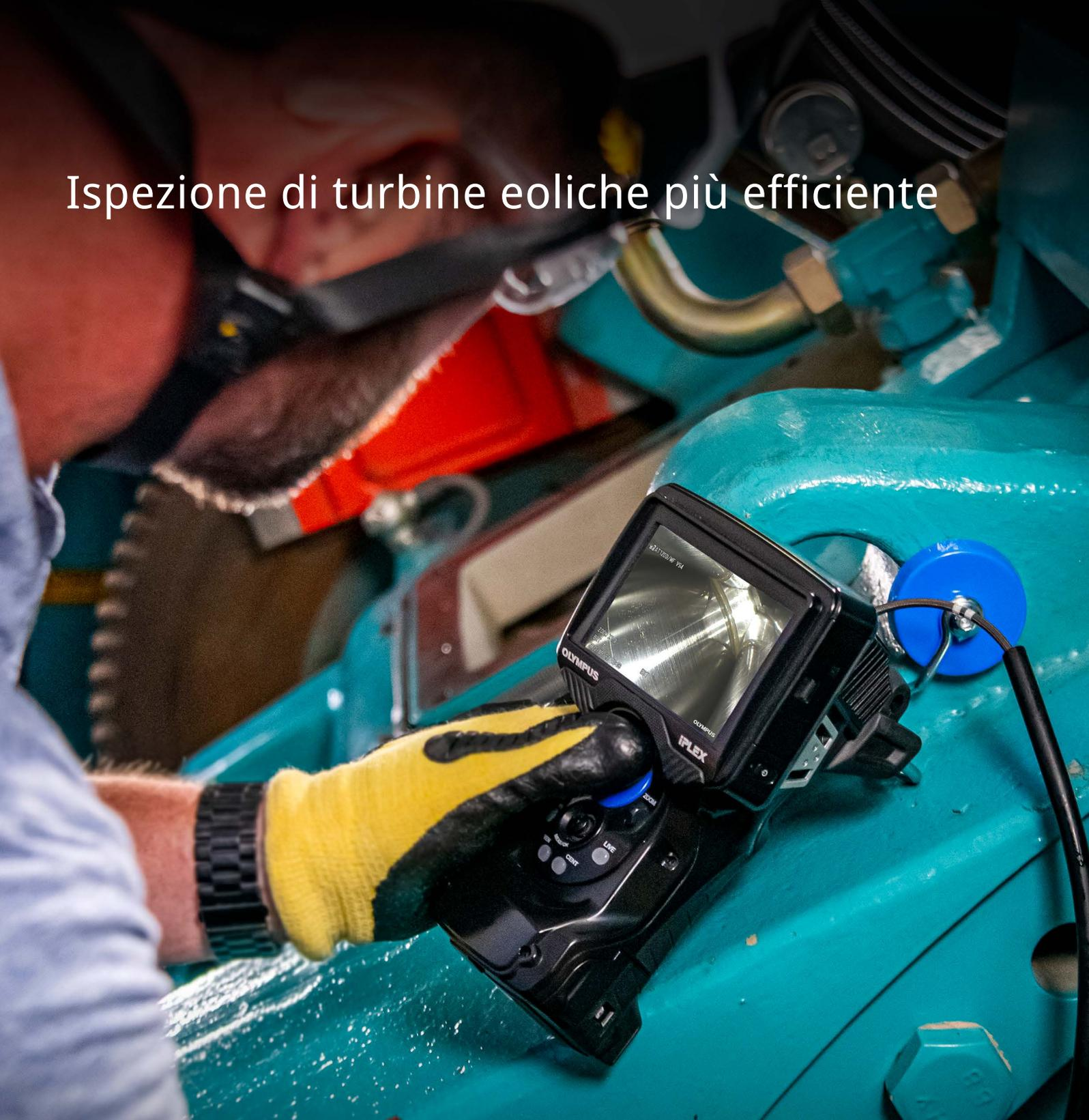
Se stai effettuando un'ispezione negli spazi limitati della carlinga di un impianto eolico, la versione dedicata del videoscopio IPLEX G Lite, con combinazione di portatilità e potenti funzionalità di imaging integrate in un telaio compatto, permette di facilitare il tuo lavoro. Questa versione di IPLEX G Lite possiede caratteristiche specificatamente progettate per l'ispezione di impianti eolici come:
