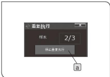
⑥ 重复执行测量时，出现[重复执行]窗口。单击[停止重复执行]按钮，停止重复执行测量。
