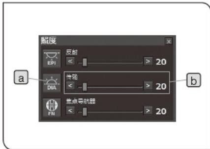
**2** 在[照明]窗口中单击
