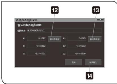
**12** 在[图形]窗口中选择直线 AB，或在[列表]窗口中选择[点到点的距离]（第一个），然后在[直线与直线的交点]窗口中单击[直线再调用]按钮。
