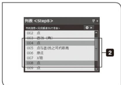
◎ 这一步骤中, 将进行三次第十四步中的重复执行测量, 然后, 分别对[样本 2]和[样本 3]中的测量项“004 点”和“008 点”实施部分测量。
