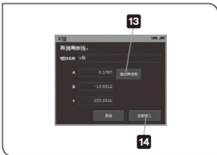
**13** 在[图形]窗口中选择直线 AB,或在[列表]窗口中选择[点到点的距离] (第一个),然后在[X 轴]窗口中单击[直线再调用]按钮。
