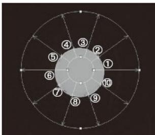
输入点位置从3点钟方向起逆时针旋转, 遵循输入点1-输入点2-输入点3等的顺序。
