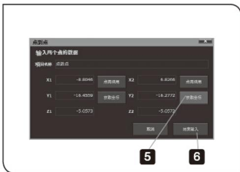
**5** 在[点到点的距离]窗口中，单击[X2/Y2/Z2]的[获取坐标]按钮。
