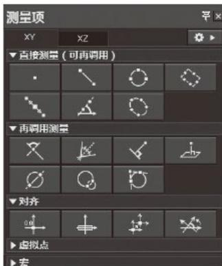
显示直接测量、再调用测量、对齐功能，以及虚拟点和宏按钮。
