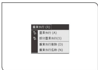
**3** 单击菜单中的
