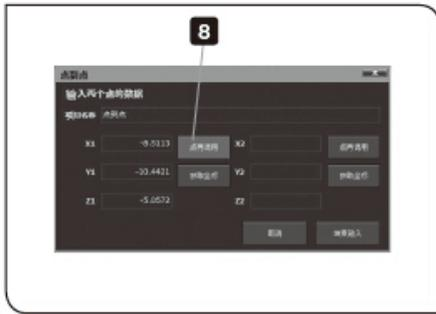
**8** 在[图形]窗口中选择点 F，或在[列表]窗口中选择[圆形]（第一个圆形），然后在[点到点的距离]窗口中单击[X1/Y1/Z1]的[点再调用]按钮。
