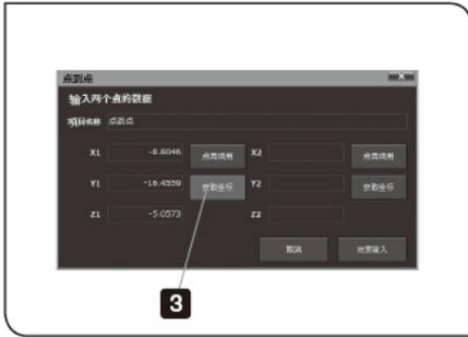
**3** 在[点到点的距离]窗口中，单击[X1/Y1/Z1]的[获取坐标]按钮。
