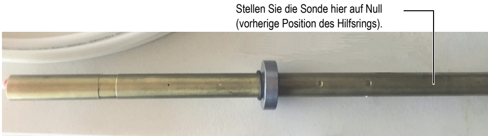
Abbildung 5-175 Nullposition nach Ausrichten des Hilfsrings
