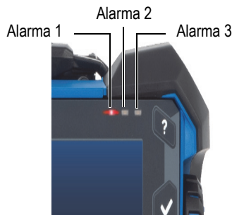
Figura 2-30 Indicadores luminosos de alarma
