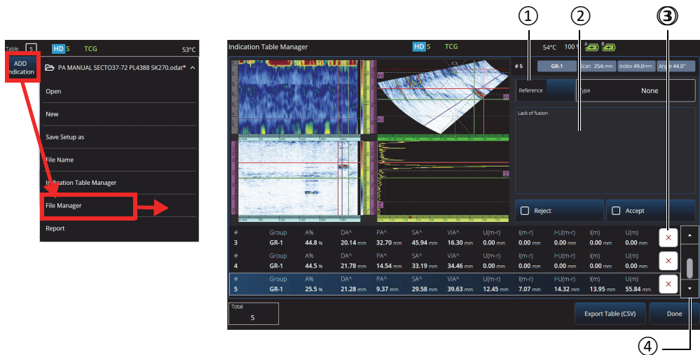
Figura 5-2 Ventana del administrador de tablas de defectos
