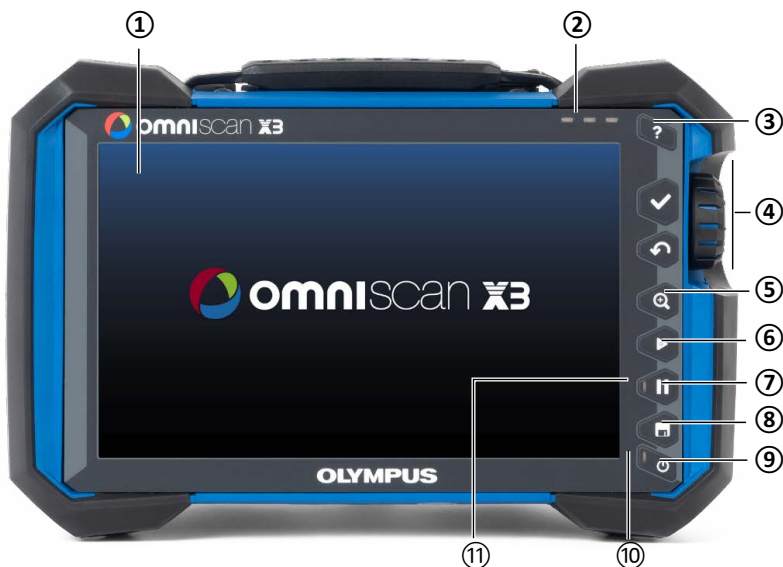
Figura 1-1 Controles do painel frontal do detector de defeitos OmniScan X3
